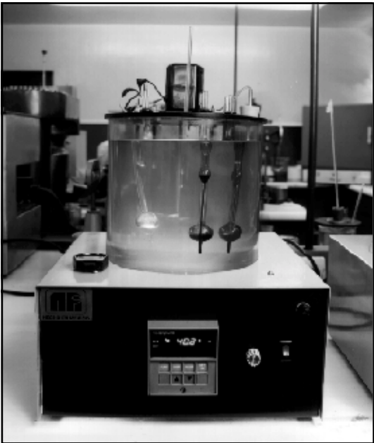
Figura 10.2 - Aparato utilizado para determinar la viscosidad cinemática.
