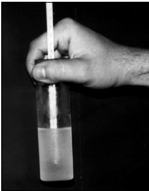
Figura 10.5 - Procedimiento para determinar el punto de floculación.
