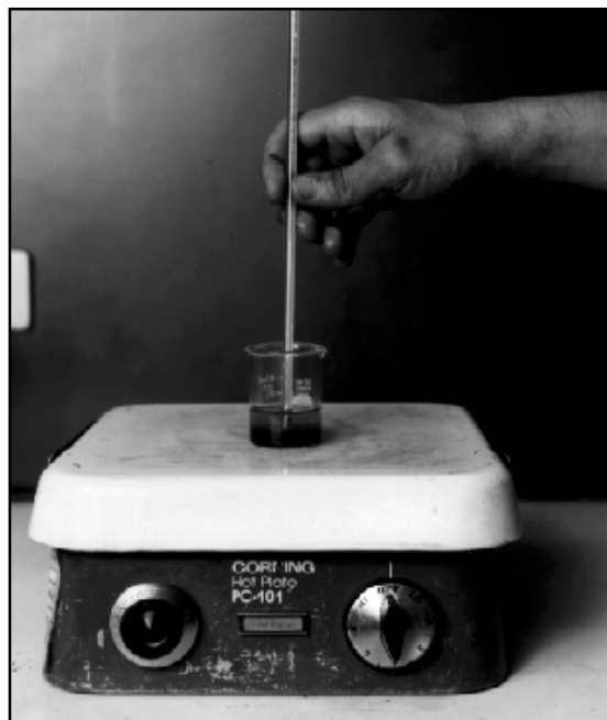
Figura 10.12 - Determinación del punto de anilina.
