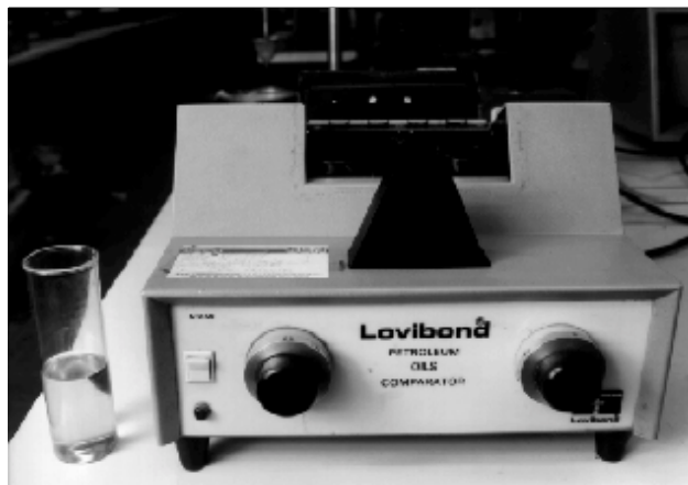
Figura 10.11 - Colorímetro utilizado para determinar el color ASTM.
