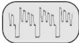
① 4.6 Vp-p A11 PIN 3 (SALIDA AZUL)
