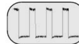
⑪ 3.20 Vp-p IC501 PIN 4 (IMPULSOR HOR.)
