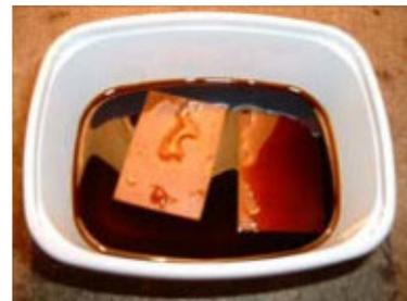
Luego de haber colocado la plaqueta en el ácido, debemos esperar media hora más o menos hasta que desaparezca el cobre que no pertenece al circuito. Para saber cuando está pronto, podemos dar vuelta la plaqueta con alguna pinza tipo Bruselas de plástico, que en caso de no conseguir, se puede fabricar con dos trozos de plástico y
