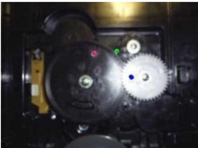
Para montar la bandeja debe girar un poco el engrane principal hacia la derecha hasta hacer coincidir el primer diente con el engrane de tracción, el primer diente debe quedar a la altura del punto azul marcado sobre el engrane de tracción, al montar la bandeja es necesario mover el engrane principal a manera de que cuando entre el primer diente con el engrane de tracción el ultimo diente del engrane principal no pierda su posición
