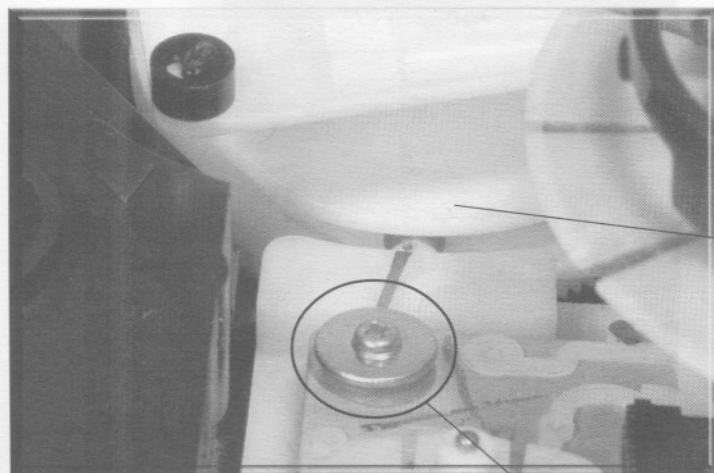
Tornillo de sujeción del pick-up
