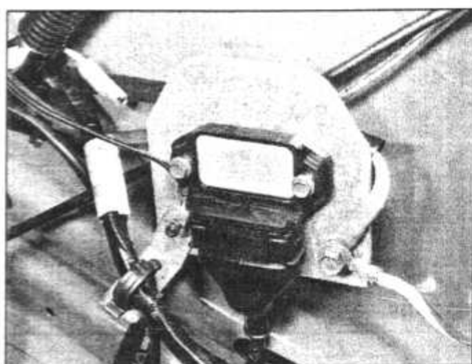
1.2 Ignition amplifier module
