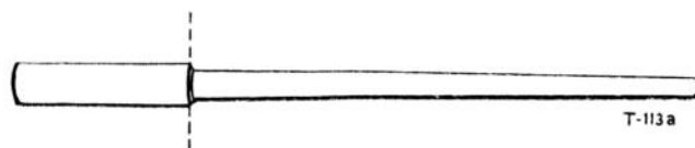
Fig. 13. SU carburettor, jet needle
