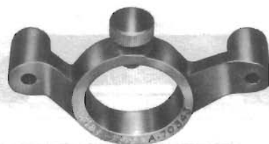
A.70343 Przyrząd do blokowania wałka napędowego przekładni głównej przy kontroli luzu międzyzębnego
