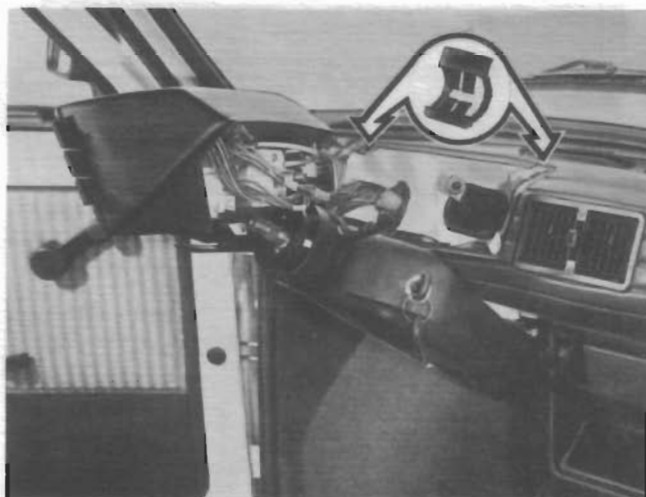
Zestaw wskaźników z przełącznikami po wymontowaniu z tablicy przyrządów – FL
