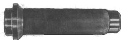
A.74041/1 Przyrząd do nabijania pierścieni zewnętrznych łożyska i uszczelniacza
