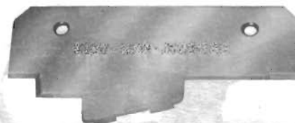
A.96235 Sprawdzian głębokości komory spalania w głowicy A.96235/1
