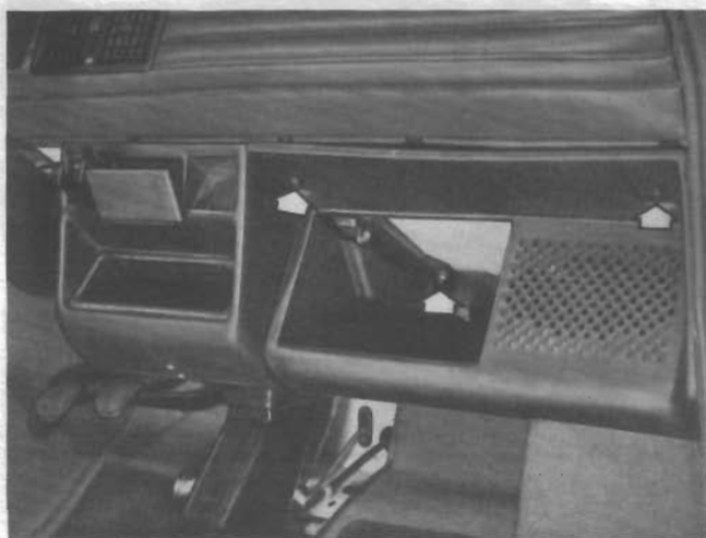
Demontaż schowka na drobne przedmioty i obudowy środkowej pod tablicę rozdzielczą przyrządów Strzałki wskazują śruby mocowania schowka i obudowy środkowej.
