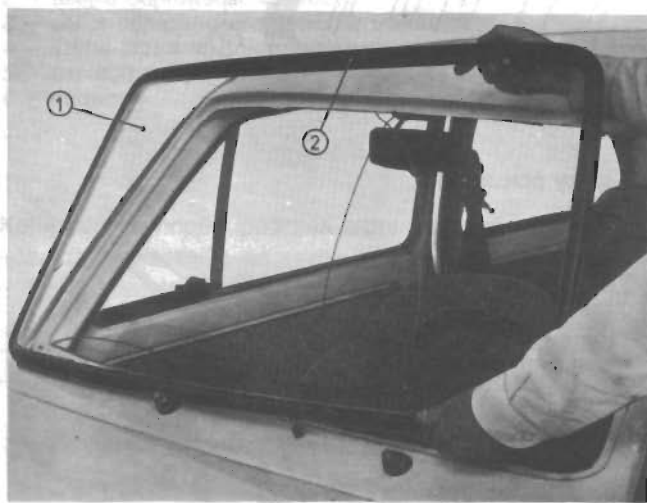
Demontaż wycieraczek
