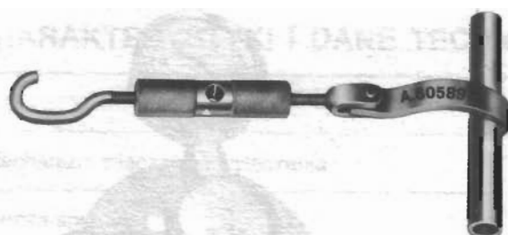
A.60589 Uchwyt podtrzymujący silnik przy montażu i demontażu belki tylnej
