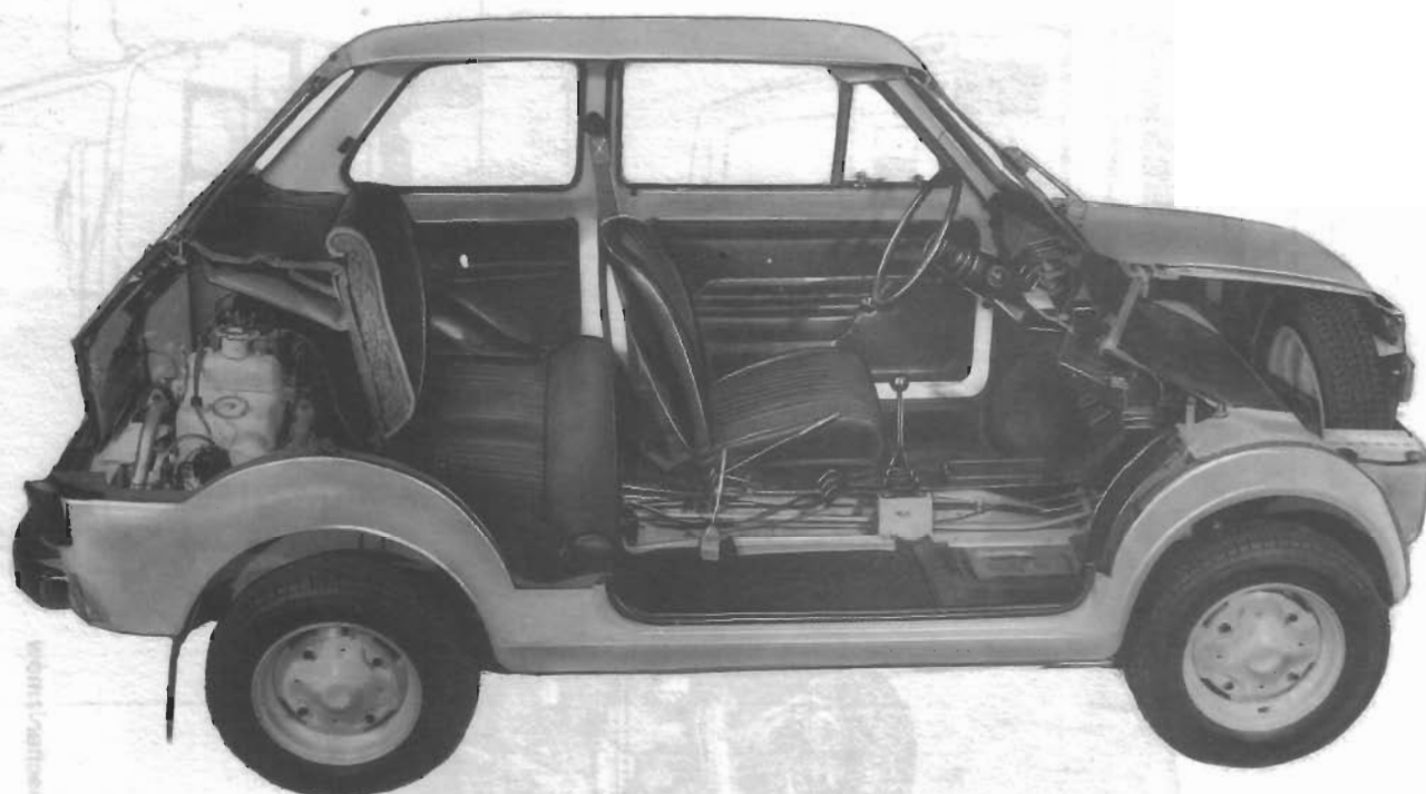
Rozmieszczenie zespołów głównych i mechanizmów
