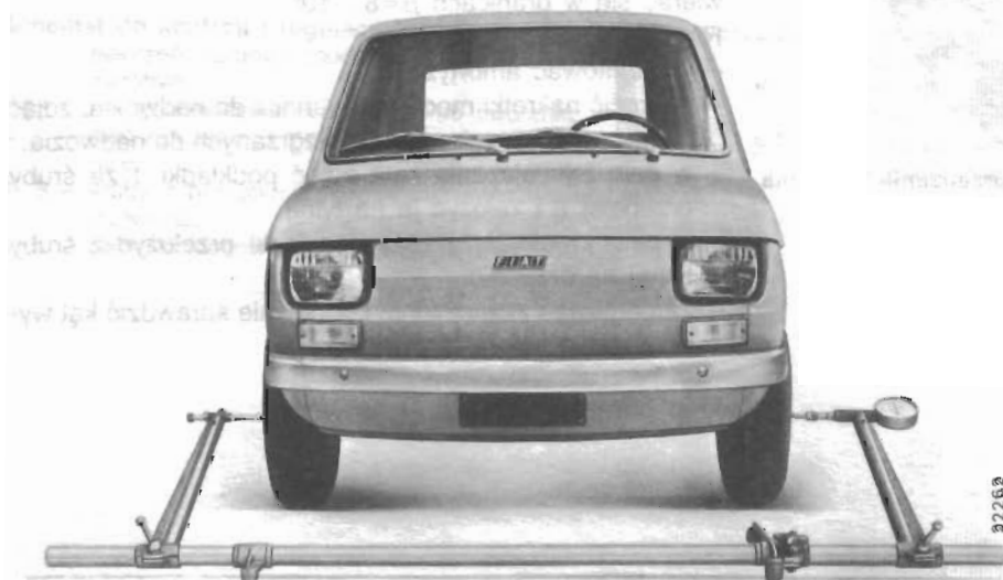
Pomiar zbieżności kół przyrządem Ap.5107
