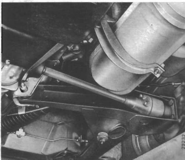
Przednia poprzeczka zawieszenia elastycznego
