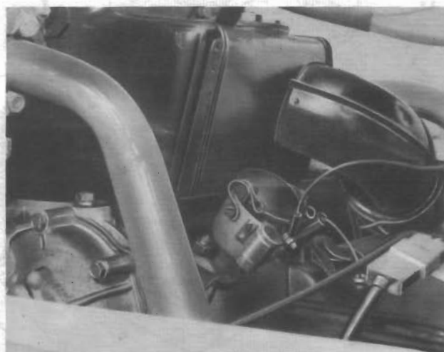
Widok na przewody prądnicy i paliwowe
