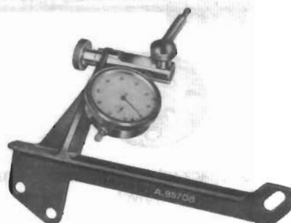
A.95708 Przyrząd do kontroli luzu międzyzębego (wałek napędowy – koło talerzowe)
