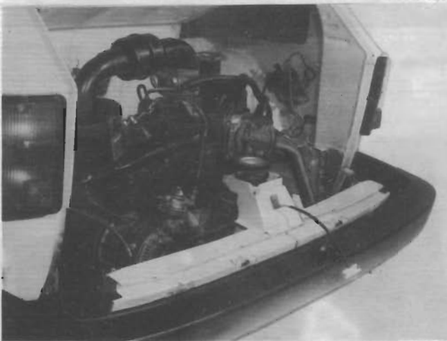
Wysunięcie silnika z samochodu (z belką tylną)
