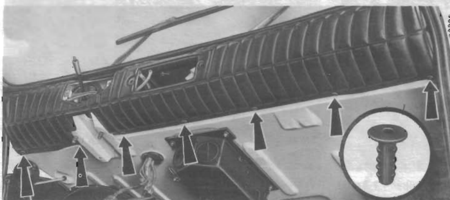
Demontaż pokrycia tablicy rozdzielczej przyrządów (w dolnej części) Strzałki wskazują miejsca mocowania pokrycia w dolnej części tablicy rozdzielczej. Szczegół przedstawia jeden z kołków zaciskowych.
