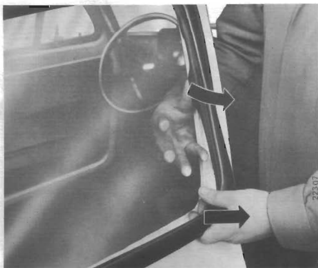
Demontaż szyby tylnej bocznej (stałej)
