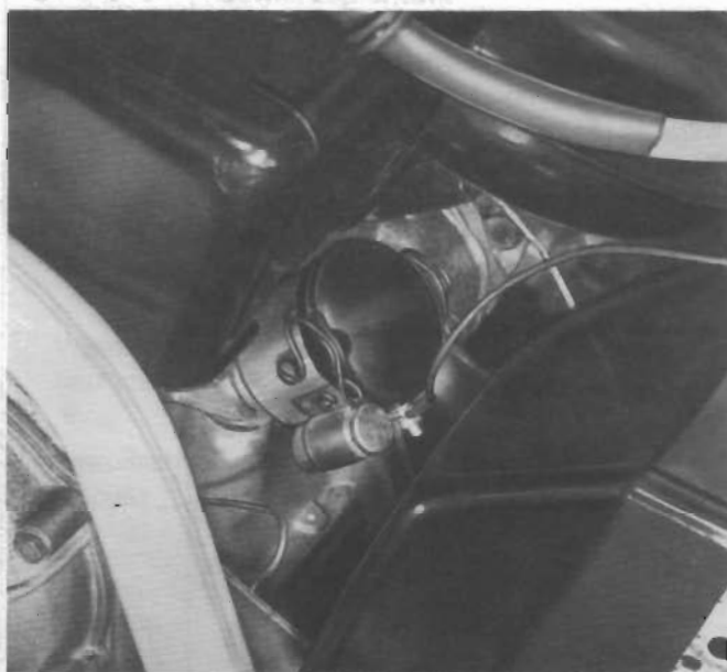
Widok ogólny aparatu zapłonowego bezrozdzielaczowego
