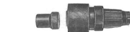
A.70315 Tuleja rozprężna do blokowania mechanizmu różnicowego z tuleją A.70315/1 łączącą półoś z dynamometrem A.95697
