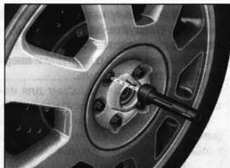
Рис. 1.145. Смена колеса: вывертывание колесных болтов
