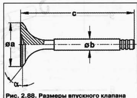
Рис. 2.88. Размеры впускного клапана
