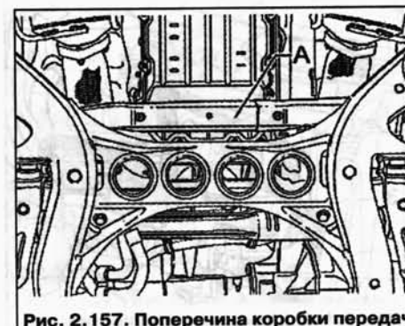
Рис. 2.157. Поперечина коробки передач
