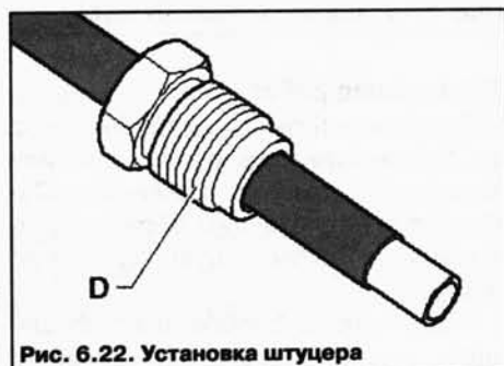
Рис. 6.22. Установка штуцера
