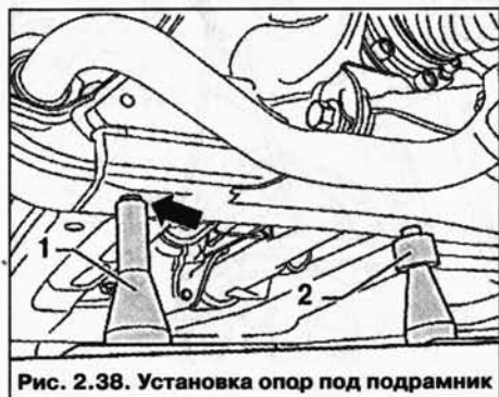
Рис. 2.38. Установка опор под подрамник
