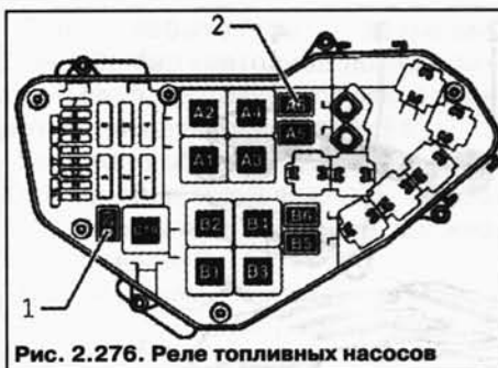
Рис. 2.276. Реле топливных насосов
