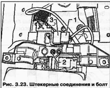
Рис. 3.23. Штекерные соединения и болт
