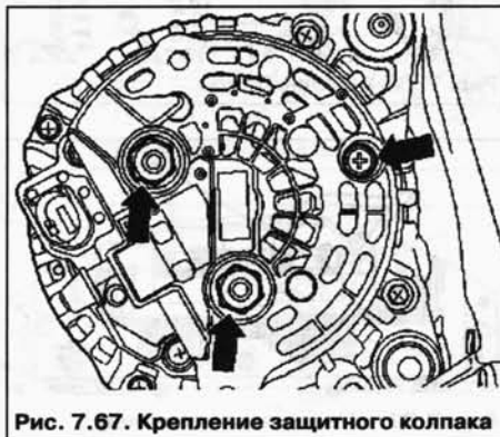
Рис. 7.67. Крепление защитного колпака
