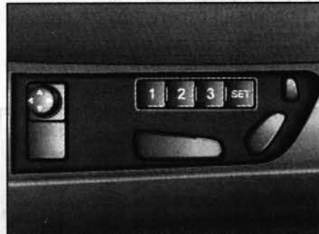
Рис. 1.91. Клавиши памяти на переднем сиденье
