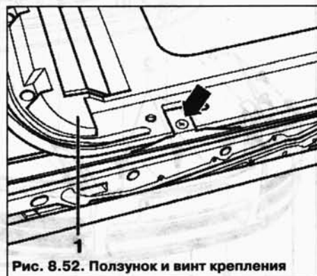
Рис. 8.52. Ползунок и винт крепления
