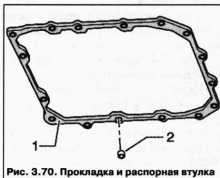
Рис. 3.70. Прокладка и распорная втулка
