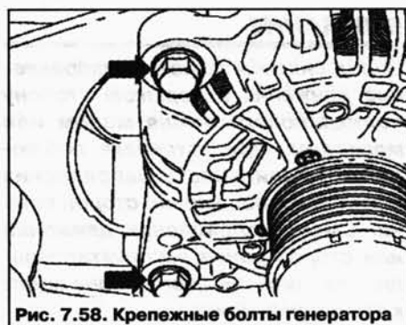
Рис. 7.58. Крепежные болты генератора
