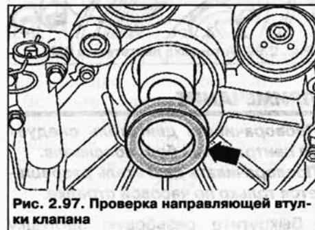
Рис. 2.96. Проверка направляющей втулки клапана
