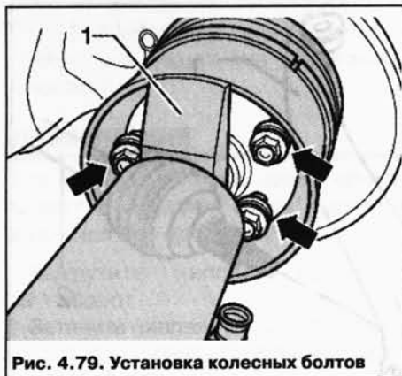
Рис. 4.79. Установка колесных болтов
