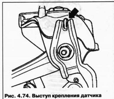
Рис. 4.74. Выступ крепления датчика
