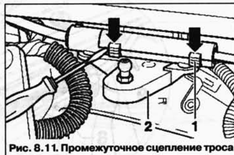
Рис. 8.11. Промежуточное сцепление троса
