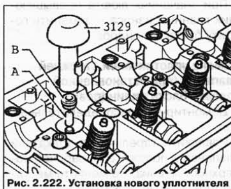
Рис. 2.222. Установка нового уплотнителя
