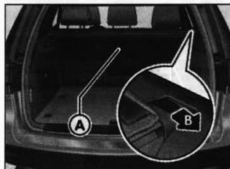
Рис. 1.68. Вытяжная ручка А и дефиксатор В для снятия полки
