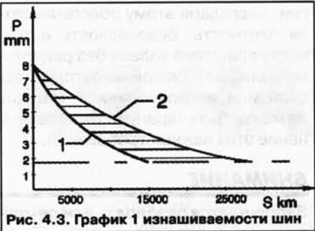
Рис. 4.3. График 1 изнашиваемости шин P – Высота рисунка протектора. S – Пробег. 1 – Передняя ось. 2 – Задняя ось.
