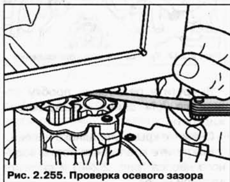
Рис. 2.255. Проверка осевого зазора
