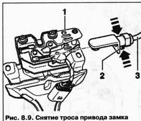
Рис. 8.9. Снятие троса привода замка
