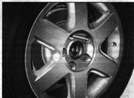
Рис. 1.146. Монтажный штифт в верхнем отверстии
