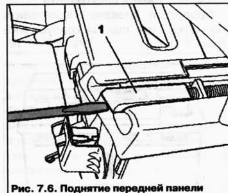
Рис. 7.6. Поднятие передней панели
