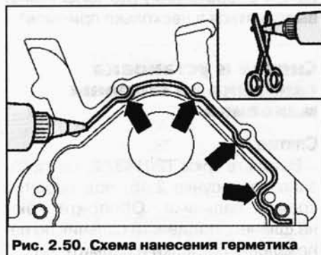
Рис. 2.50. Схема нанесения герметика
