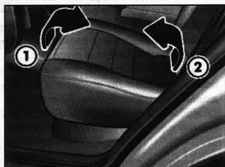
Рис. 1.94. Складывание подушки отдельного сиденья
