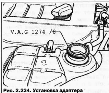
Рис. 2.234. Установка адаптера
