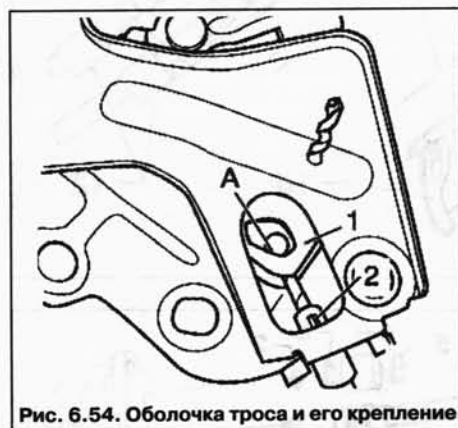
Рис. 6.54. Оболочка троса и его крепление
