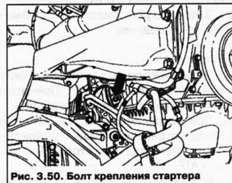
Рис. 3.50. Болт крепления стартера
