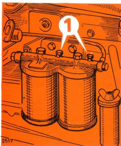
FIG. 9 — Filtre à combustible.
