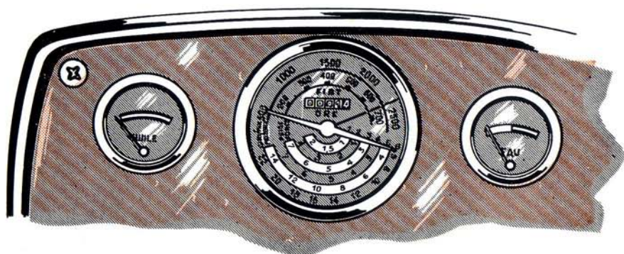
FIG. 22 — Horomètre. Au centre de l'horotachymètre.
