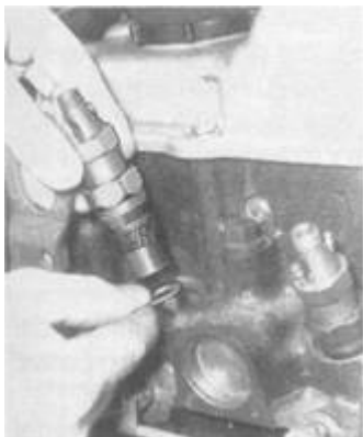
Rys. 3.6. Wyjmowanie wtryskiwacza i jego podkładki izolacji cieplnej (fot. RTA)
