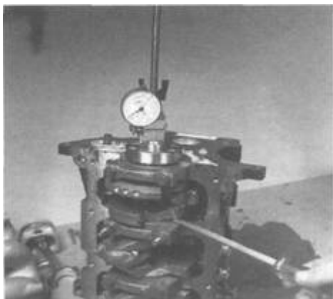
Rys. 2.34. Pomiar luzu osiowego wału korbowego
