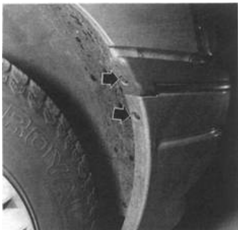
Rys. 13.5. Usytuowanie śrub bocznego mocowania zderzaka przedniego
