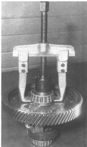
Rys. 5.15. Ściąganie łożyska z obudowy mechanizmu różnicowego
