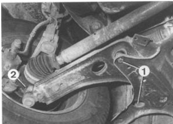
Rys. 9.6. Sposób zamocowania wahacza zawieszenia 1—elementy mocowania do ramy pomocniczej, 2—mocowanie do zwrotnicy koła
