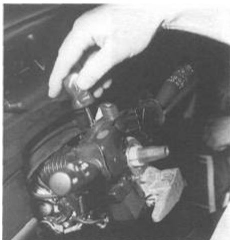
Rys. 12.17. Wymontowanie zespołu przełączników pod kierownicą
