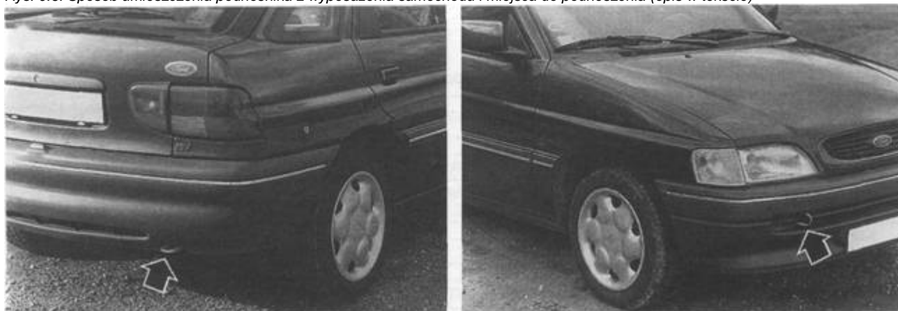
Rys. 0.7. Zaczepy do holowania z tyłu (rys. lewy) i z przodu (rys. prawy)
