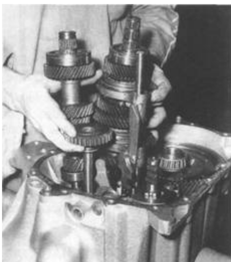
Rys. 5.10. Równoczesne wyjmowanie z obudowy sprzęgła wałków sprzęgłowego i głównego oraz koła pośredniego biegu wstecznego wraz z jego osią
