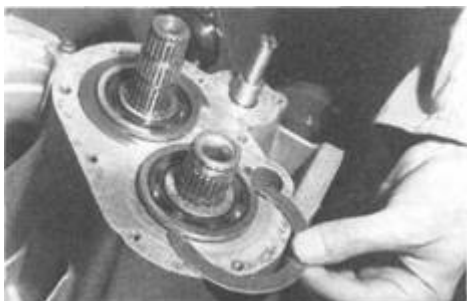
Rys. 5.22. Zamontowanie sprężystych pierścieni osadczych łożysk wałków w obudowie Dostępne są pierścienie osadcze łożysk wałków o trzech grubościach
