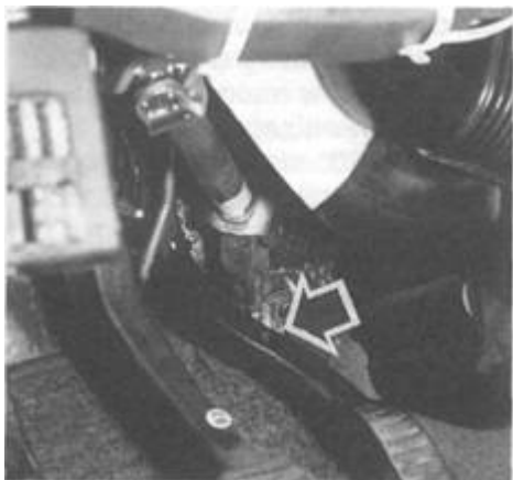
Rys. 8.2. Śruba obejmy zaciskowej mocowania zębника przekładni kierowniczej do wału kierownicy
