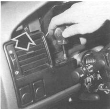
Rys. 12.19. Usytuowanie dwóch wkrętów mocowania kratki nadmuchu powietrza
