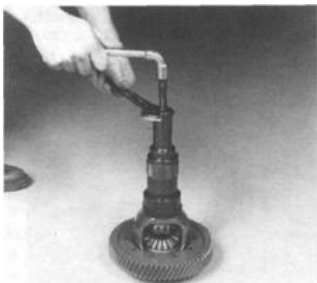
Rys. 6.8. Wymontowanie łożyska stożkowego z pierścieniem wewnętrznym z obudowy mechanizmu różnicowego
