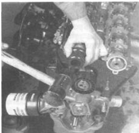
Rys. 2.29. Zamontowanie pierścienia uszczelniającego wał rozrządu
