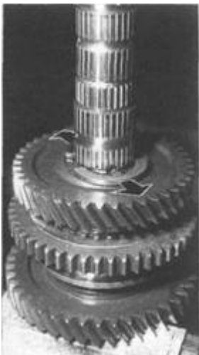
Rys. 5.11. Zdejmowanie z wałka głównego pierścienia osadczego (rys. lewy) oraz dwóch półpierścieni ustalających koło zębate 2. biegu (rys. prawy)
