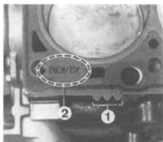
Rys. 2.25. Oznaczenie identyfikacyjne grubości (1) uszczelki głowicy i oznaczenie jej górnej powierzchni (2)
