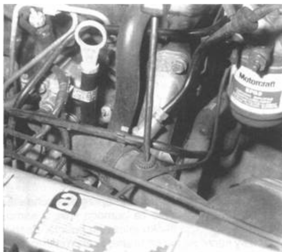
Rys. 3.41. Odpowietrznik układu chłodzenia wskazany ostrzem wkrętaka (fot. RTA)
