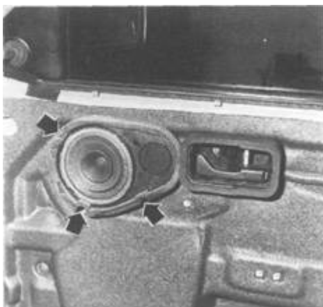
Rys. 13.14. Usytuowanie śrub mocowania głośnika
