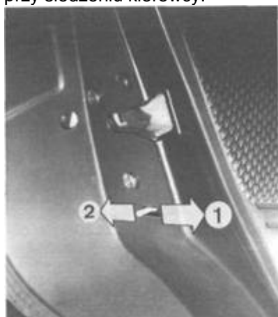
Rys. 0.36. Położenia dźwigni blokowania zamka tylnych drzwi bocznych 1 — zablokowanie możliwości otwarcia drzwi od wewnątrz, 2 — możliwe otwarcie drzwi od wewnątrz
