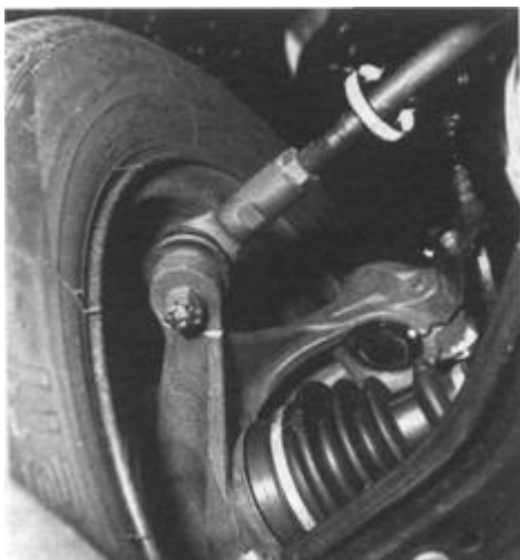
Rys. 9.8. Regulacja zbieżności kół przednich
