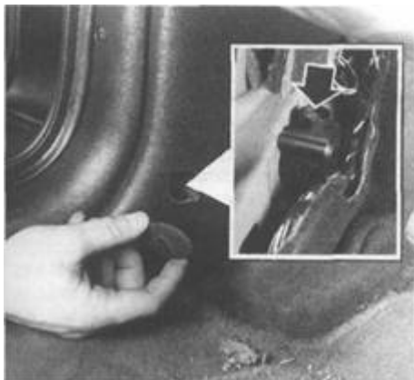
Rys. 2.15. Usytuowanie wyłącznika bezwładnościowego Strzałką wskazano kierunek nacisku w celu przywrócenia zasilania elektrycznego pompy paliwa
