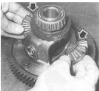
Rys. 5.13. Wyjmowanie kół koronowych pófosi z obudowy mechanizmu różnicowego
