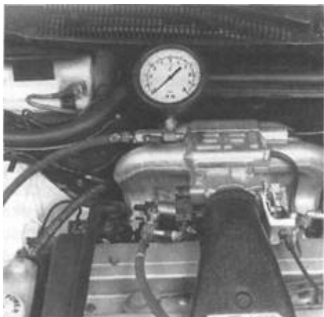
Rys. 2.11. Pomiar ciśnienia paliwa
