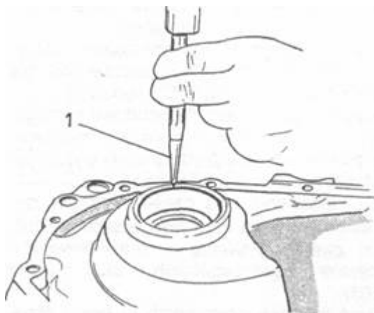
Rys. D.83. Sposób unieruchomienia w obudowie zewnętrznego pierścienia lewego łożyska stożkowego mechanizmu różnicowego
