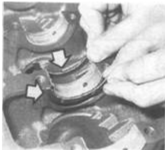
Rys. 3.31. Zakładanie półpięści oporowych wału korbowego (fot. RTA)
