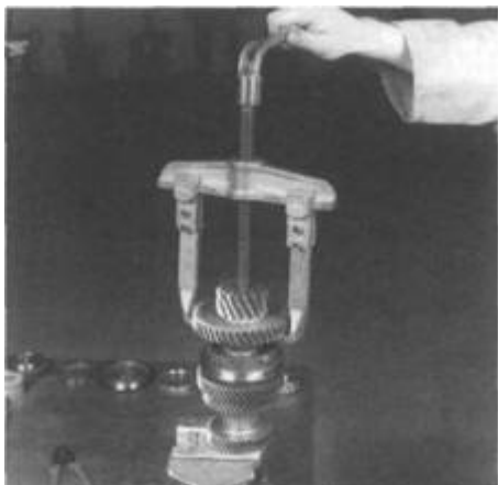
Rys. 6.7. Ściąganie z wałka głównego koła zębatego 1. biegu oraz zębniaka przekładni głównej
