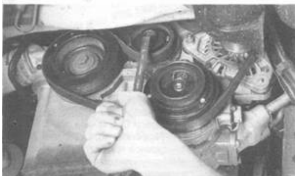
Rys. 12.5. Regulacja naciągu paska wieloklinowego silników benzynowych szesnastozaworowych z napinaczem samoczynnym
