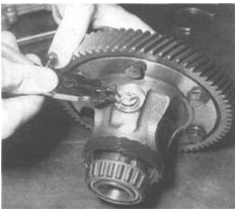
Rys. 5.14. Wyjmowanie sprężystego pierścienia osadczego osi satelitów
