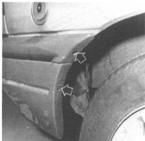
Rys. 13.29. Usytuowanie śrub bocznego mocowania zderzaka tylnego
