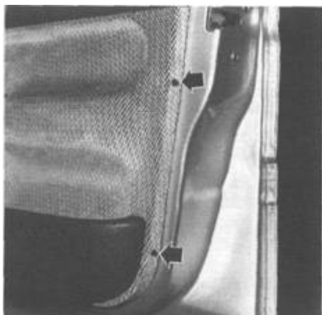
Rys. 13.13. Usytuowanie śrub mocowania pokrycia drzwi bocznych Pokrycie drzwi przednich jest mocowane 7 śrubami, zaś pokrycie drzwi tylnych 6 śrubami
