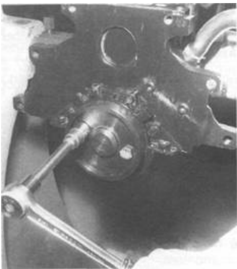
Rys. 1.45. Zamontowanie tylnego pierścienia uszczelniającego wał korbowy za pomocą przyrządu Ford 21-095
