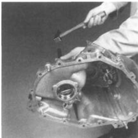
Rys. 6.10. Wymontowanie z obudowy sprzęgła zewnętrznego pierścienia łożyska stożkowego obudowy mechanizmu różnicowego za pomocą przyrządu 15-074
