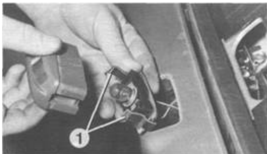
Rys. 0.32. Wymiana żarówki lampy oświetlenia tablicy rejestracyjnej (fot. RTA) 1 —zaczepki sprężyste mocowania oprawy żarówki
