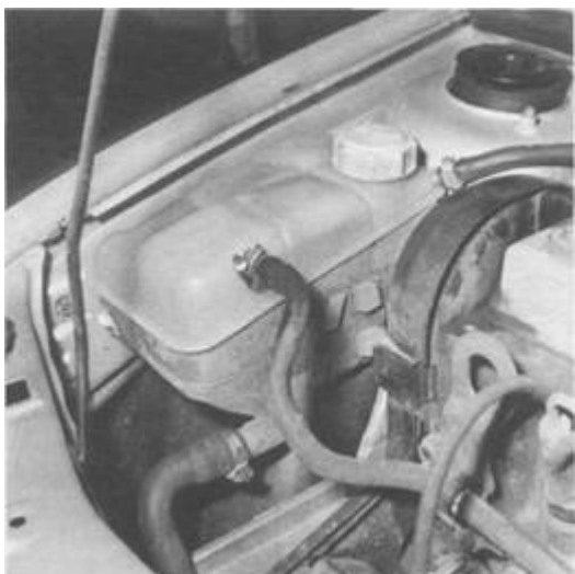
Rys. 0.65. Usytuowanie zbiornika wyrównawczego układu chłodzenia w przedziale silnika wysokoprężnego (fot. RTA)
