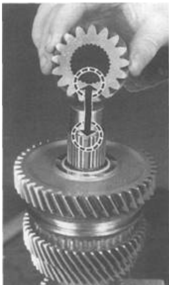
Rys. 6.17. Zamontowanie zębniaka przekładni głównej Należy zgrać wycięcie w piaście zębniaka z wypustem na wałku głównym
