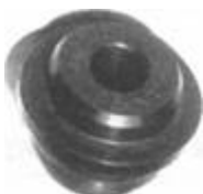
Rys. 14.9. Przyrząd 15-031 do zamontowania pierścienia zewnętrznego łożyska piasty koła tylnego
