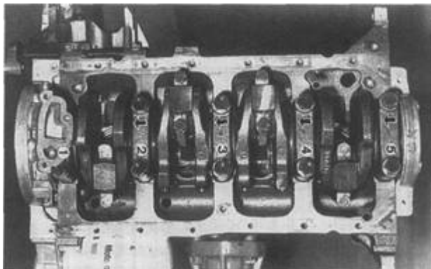
Rys. 3.34. Numeracja pokryw łożysk głównych i strzałki skierowane w stronę napędu rozrządu (fot. RTA)
