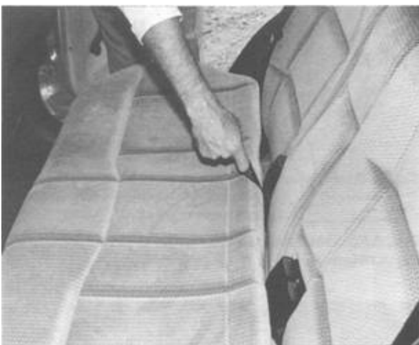
Rys. 0.55. Składanie siedziska siedzenia tylnego (fot. RTA)
