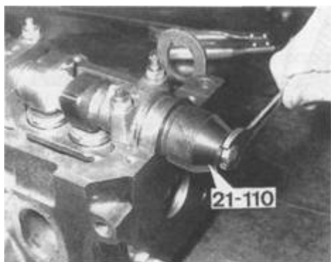
Rys. 3.22. Zamontowanie pierścienia uszczelniającego wał rozrządu za pomocą przyrządu 21-110 (fot. RTA)
