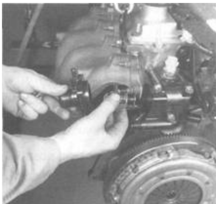
Rys. 2.44. Zamontowanie termostatu
