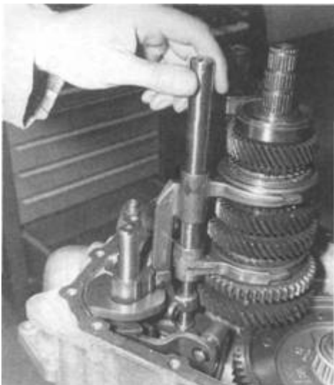
Rys. 5.19. Zamontowanie tulei prowadzącej wewnętrznego mechanizmu zmiany biegów
