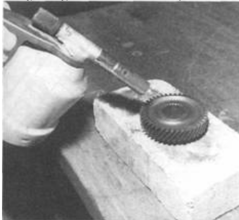
Rys. 5.23. Podgrzewanie koła zębatego 5. biegu do temperatury 180°C przed założeniem na wałek sprzęgłowy
