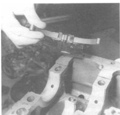
Rys. 1.39. Wyjmowanie odrzutnika oleju z kadłuba
