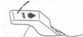
Rys. 0.37. Dźwignia otwierania zamka pokrywy bagażnika
