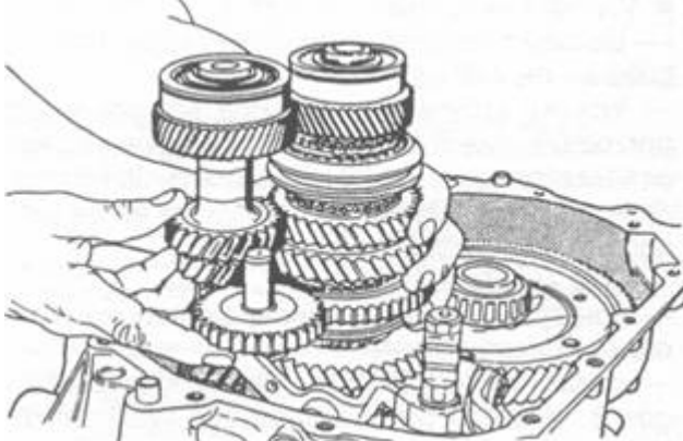
Rys. D.69. Wyjmowanie z obudowy sprzęgła mechanizmu różnicowego
