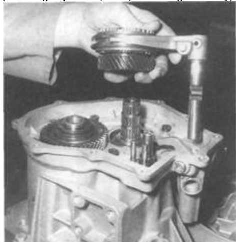
Rys. 5.7. Wyjmowanie zespołu koła zębatego z synchronizatorem, widelkami i osią wideltek 5. biegu
