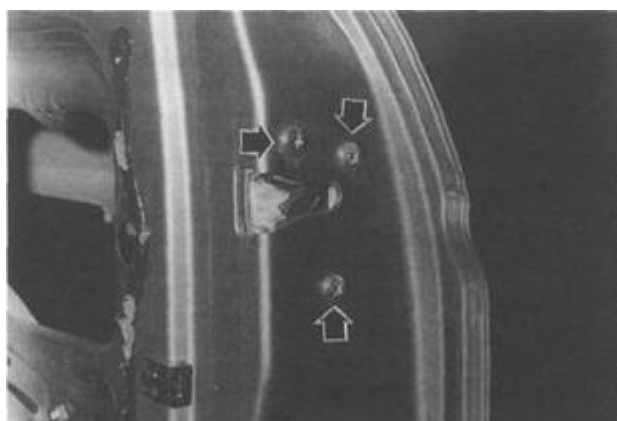
Rys. 13.22. Usytuowanie śrub mocowania klamki zewnętrznej oraz zamka drzwi przednich
