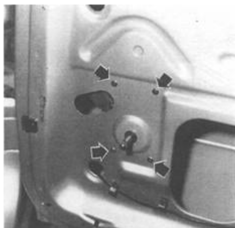
Rys. 13.20. Usytuowanie śrub mocowania mechanizmu podnoszenia szyby do szkieletu drzwi tylnych
