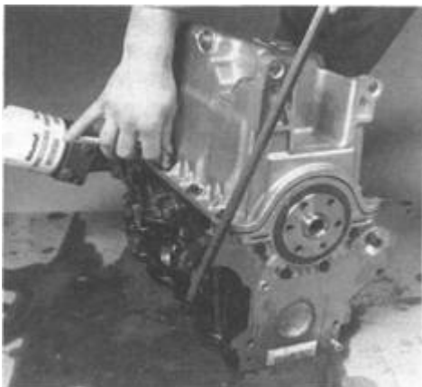
Rys. 2.38. Wzajemne ustawienie powierzchni styku kadłuba silnika oraz miski olejowej podczas montażu miski olejowej
