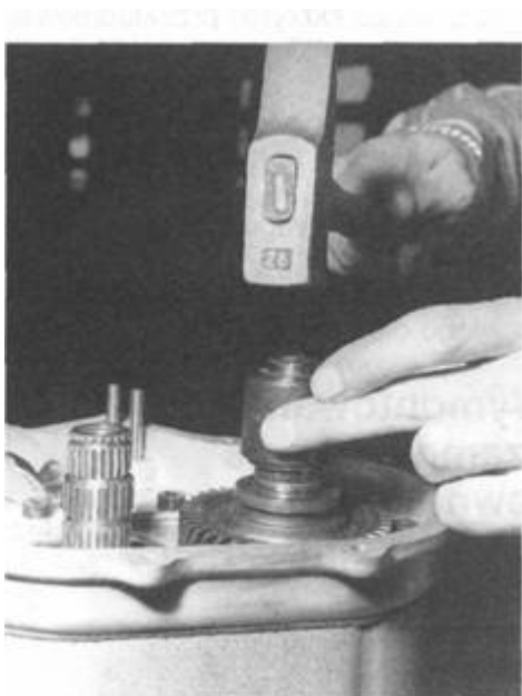
Rys. 5.24. Zamontowanie sprężystego pierścienia osadczego koła zębatego 5. biegu na wałku sprzęgłowym za pomocą przyrządu Ford 16-031
