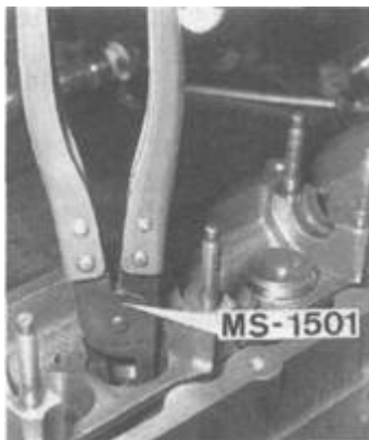
Rys. 3.16. Wyciąganie uszczelnacza trzonka zaworu za pomocą przyrządu MS-1501 (fot. RTA)
