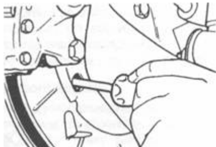
Rys. 11.15. Regulacja hamulca awaryjnego (tylne hamulce tarczowe)
