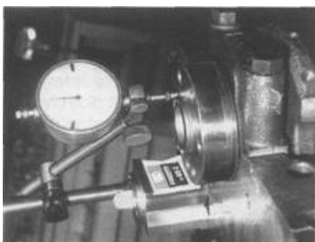
Rys. 3.32. Pomiar luzu osiowego wału korbowego (fot. RTA)
