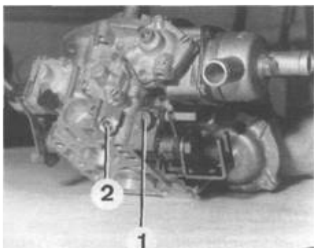
Rys. 1.11. Usytuowanie wkrętów regulacji biegu jałowego 1—wkręt regulacji prędkości obrotowej, 2—wkręt regulacji składu mieszanki
