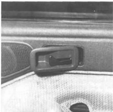
Rys. 13.12. Wymywanie obudowy klamki wewnętrznej drzwi bocznych
