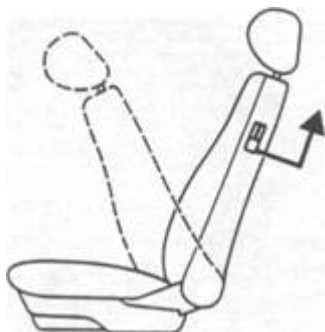
Rys. 0.52. Składanie oparcia siedzenia przedniego wersji trzydrzwiowej
