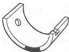
Rys. D.42. Oznaczenie identyfikacyjne panewek
