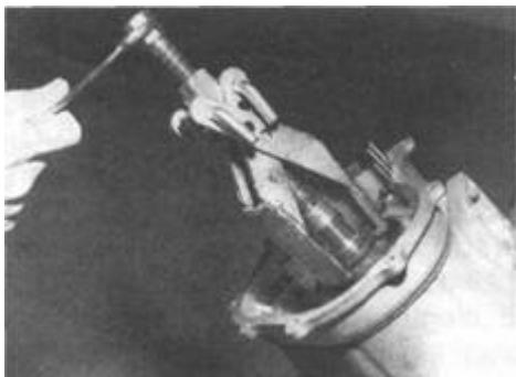
Rys. 5.8. Wymontowanie koła zębatego 5. biegu z wałka sprzęgłowego za pomocą ściągacza uniwersalnego
