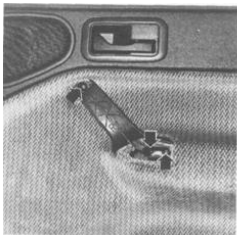
Rys. 13.11. Usytuowanie śrub mocowania uchwyty wewnętrzne drzwi
