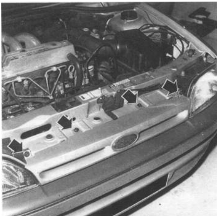
Rys. 13.3. Usytuowanie śrub mocowania przedniej osłony ozdobnej wlotu powietrza w modelach do lipca 1992
