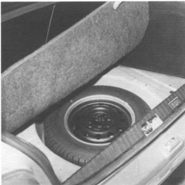
Rys. 0.57. Miejsce umieszczenia koła zapasowego, podnośnika i klucza do nakrętek kół w modelach Escort i Orion (fot. RTA)
