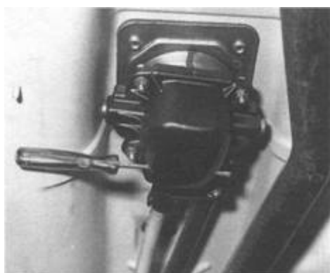
Rys. 5.28. Regulacja dźwigni zmiany biegów za pomocą narzędzia specjalnego o średnicy 3,5 mm
