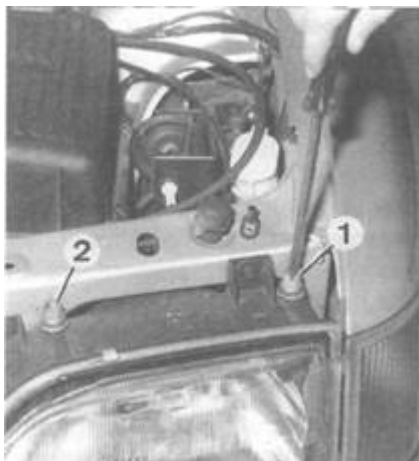
Rys. 12.9. Regulacja ustawienia światła reflektorów 1 — regulacja w poziomie, 2 — regulacja w pionie
