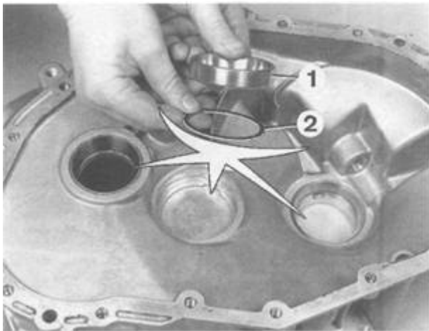
Rys. 6.22. Zakładanie podkładek regulacyjnych w obudowie sprzęgła 1 — zewnętrzny pierścień łożyska stożkowego, 2 — podkładka regulacyjna
