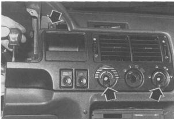
Rys. 12.18. Wymontowanie płyty czołowej przełączników regulacji ogrzewania i przewietrzania wnętrza
