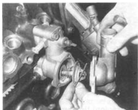
Rys. 3.36. Sposób montażu termostatu (fot. RTA)
