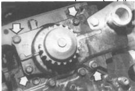
Rys. 1.48. Usytuowanie śrub mocowania pompy cieczy chłodzącej
