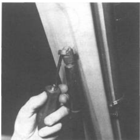
Rys. 13.24. Wymontowanie sprężyny gazowej z drzwi tyłu nadwozia
