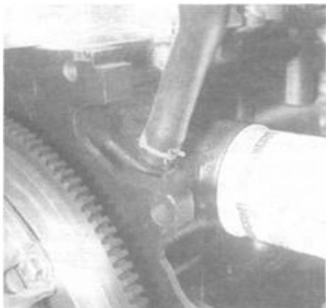
Rys. 1.32. Przewód przewietrzania skrzyni korbowej silnika
