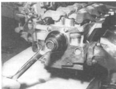
Rys. 1.30. Zamontowanie pierścienia uszczelniającego wał rozrządu
