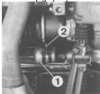
Rys. 2.9. Mocowanie filtra paliwa 1 —filtr paliwa, 2— obejma mocowania filtra
