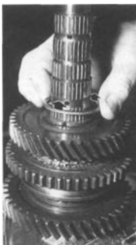
Rys. 5.10. Równoczesne wyjmowanie z obudowy sprzęgła wałków sprzęgłowego i głównego oraz koła pośredniego biegu wstecznego wraz z jego osią
