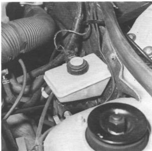
Rys. 0.70. Usytuowanie zbiornika płynu hamulcowego w przedziale silnika wysokoprężnego (fot. RTA)
