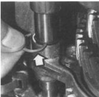
Rys. 5.20. Zakładanie sprężystego pierścienia osadczego widełek na tulei prowadzącej
