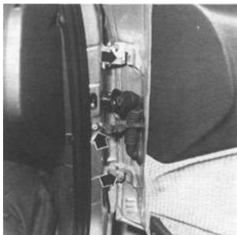
Rys. 13.8. Sposób wymontowania drzwi
