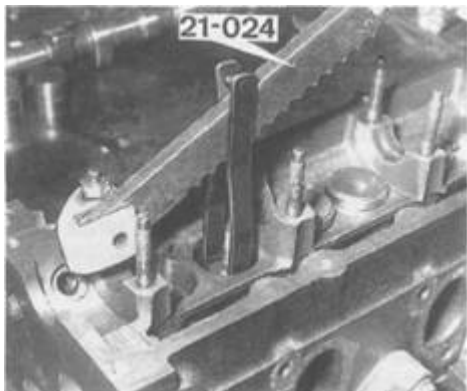
Rys. 3.18. Ściskanie sprężyny zaworu za pomocą przyrządu 21-024 (fot. RTA)
