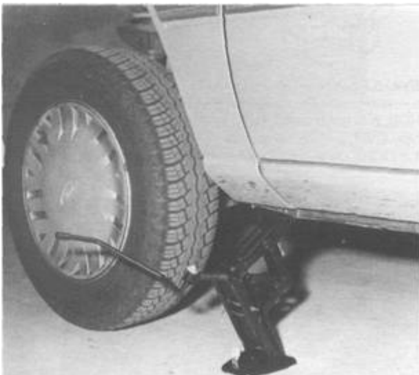
Rys. 0.59. Sposób założenia podnośnika (fot RTA)
