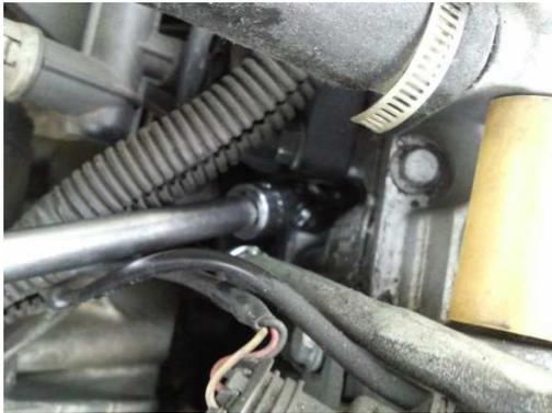
Con el motor en frío (para evitar daños a la rosca donde se aloja la bujía) removemos las bujías con un dado de 5/8" o 16mm para bujías, una a la vez, comenzando por la bujía 1, los cables de bujías originales Fiat o NGK están numerados; si no fuese ese el caso enumérelos con cinta adhesiva para volverlos a colocar en su sitio.
