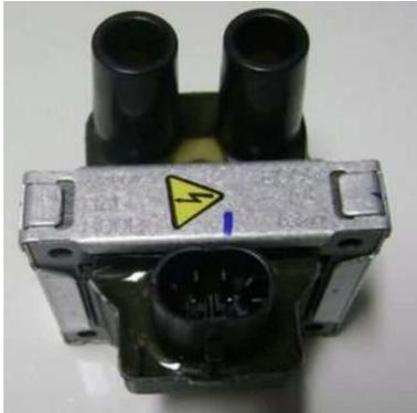
La bobina del encendido es un dispositivo de inducción electromagnética o inductor, que forma parte del encendido de un motor de combustión interna alternativo de ciclo Otto o Wankel, que cumple con la función de elevar el voltaje normal de a bordo (6, 12 o 24 V, según los casos) en un valor unas 1000 veces mayor con objeto de lograr el arco eléctrico o chispa en la bujía, para permitir la inflamación de la mezcla aire/combustible en la
