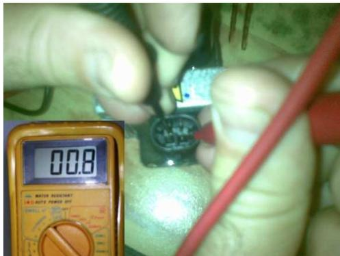
Ahora medimos la resistencia secundaria. Para ello seleccionamos la escala  $20K\Omega$  e introducimos las puntas del multímetro en las salidas de la bobina; los valores de resistencia deben estar entre  $7.30K\Omega$  y  $7.50K\Omega$ .
