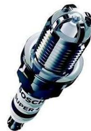
importante observar que en este tipo de bujías será solamente una chispa la que saltará a la vez. Por lo tanto un motor con bujías de multi-electrodos no realizará chispas múltiples, sencillamente la chispa brincara al electrodo que le sea más fácil, de esto dependerá la calibración, limpieza y las corrientes dentro de la cámara de combustión.
