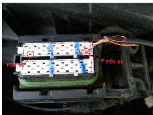
Para medir la continuidad del cable positivo en las bobinas ubicamos el enchufe del ramal. Se encuentra debajo del caucho de repuesto y al lado del recipiente del líquido de frenos, tal como se ve en la imagen.
