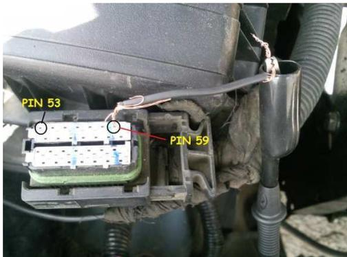
Medimos la continuidad del cable negativo de la bobina en los cilindros 1-4. Introducimos un cable en el pin 59 del enchufe de la ECU y al otro extremo conectamos una de las puntas al multímetro.
