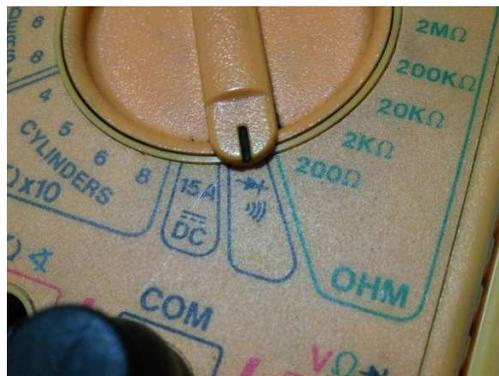
Para medir la continuidad del cable negativo de la bobina de los cilindros 2-3 introducimos un cable en el pin 66 del enchufe de la ECU. Repetimos los pasos anteriormente descritos para la bobina en los cilindros 1-4
