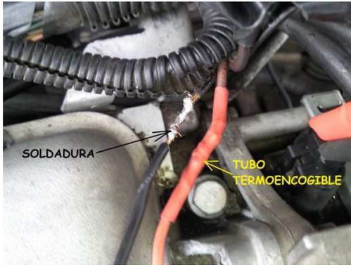
Cortamos y empalmamos con los cables del enchufe nuevo: cable rojo del enchufe (positivo) con cable marrón con línea negra del ramal; cable negro del enchufe (negativo) con cable marrón claro del ramal. Seguidamente y para mayor seguridad soldamos los empalmes y los
