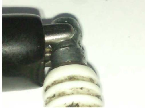
La punta positiva del multímetro la conectamos al electrodo central de la bujía
