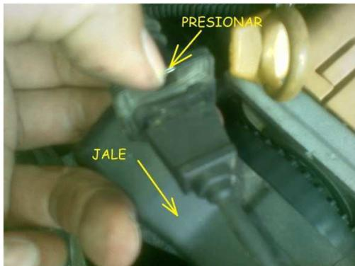
Sacamos con cuidado el cable del sensor que esta embutido dentro de la cubierta de la correa de distribución.
