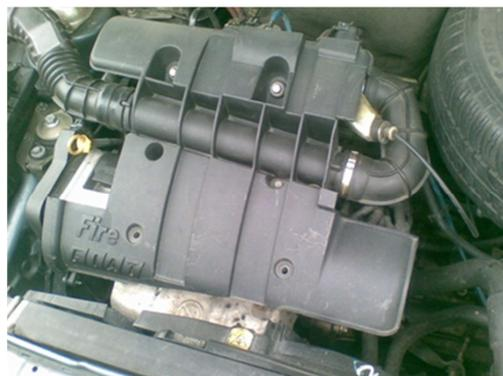
Procedemos a sacar la bobina, para ello utilizamos una herramienta Torx T-25 (bien sea dado, llave o, como en este caso una punta con un ratchet de  $\frac{1}{4}$ "") para sacar los 4 tornillos que sujetan la bobina a su base, este caso es recomendable cambiar las 2 bobinas para igualar la intensidad de la chispa en ambas.
