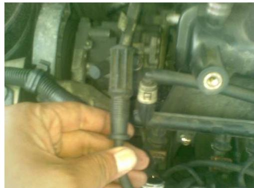
De igual forma de la bobina, recordando siempre el orden de los mismos. Un punto a verificar (ya habiendo desconectado los cables de bujía), es el estado de los terminales en ambos extremos del cable como así también el alojamiento del distribuidor o bobina tipo DIS. Éstos no deben tener rastros de corrosión. En caso de haberlo proceder a eliminarlo. Proteja
