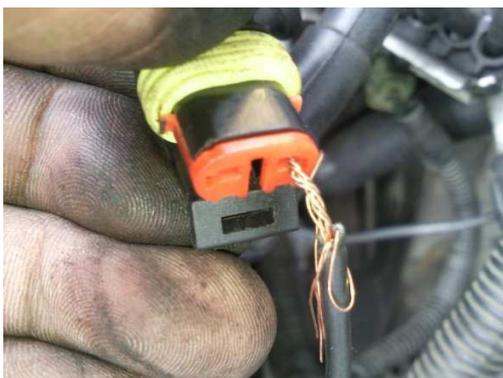
Introducimos un cable en el positivo del enchufe de la bobina en los cilindros 1-4. Conectamos con la punta del multímetro el pin del enchufe del ramal y seleccionamos la función continuidad en el multímetro; Este emitirá un sonido indicando que el cable está en buen estado. Repita el paso con la bobina en los cilindros 2-3.
