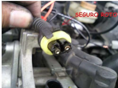
Este es el conector de reemplazo. El cable negro corresponde al negativo de la bobina y el rojo al positivo de la bobina.
