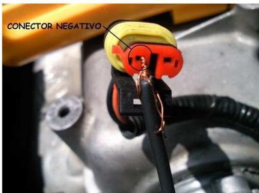
Sacamos el enchufe de la bobina de los cilindros 1-4, e introducimos un cable en el enchufe negativo de este. De igual forma lo haremos a la punta del multímetro.
