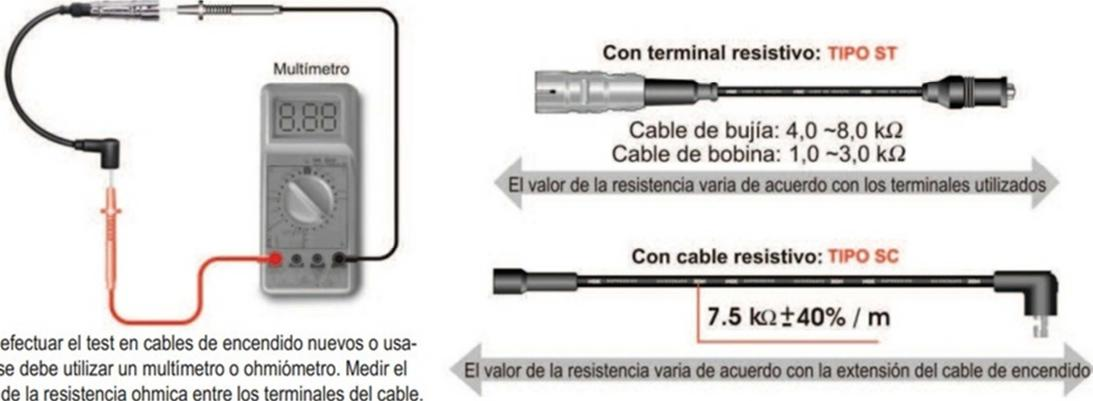
Para efectuar el test en cables de encendido nuevos o usados, se debe utilizar un multímetro o ohmiómetro. Medir el valor de la resistencia ohmica entre los terminales del cable.
