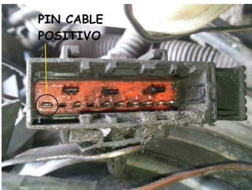
Por el lado de atrás del conector buscamos el cable positivo de la bobina, para este caso es un cable grueso marrón con una línea negra. Al identificarlo nos damos cuenta que el pin correspondiente a este cable es el que se ve en la imagen. El cable positivo es común tanto para las bobinas como para los inyectores.
