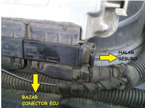
El primer paso: verificar el estado de los enchufes y cables de las bobinas, para ello sacamos el enchufe de la ECU, tal como se aprecia en la imagen. La ECU es Magneti Marelli IAW 4AFB UB1
