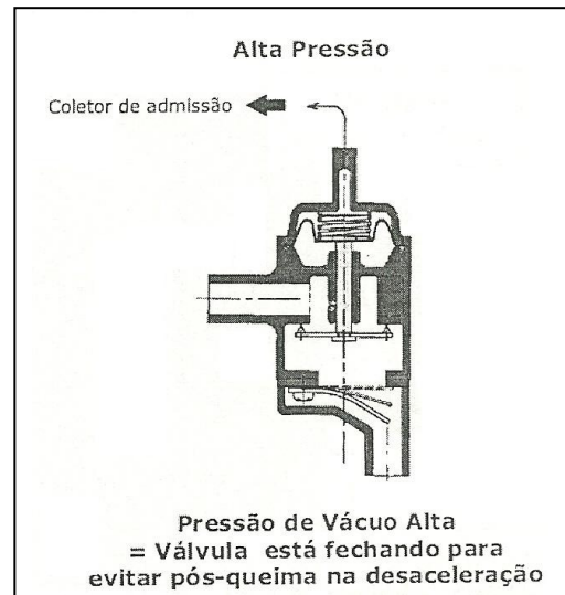
Figura 50 – comportamento da válvula(fechada)
