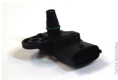
Figura 14 – Sensor de temperatura e pressão absoluta.
