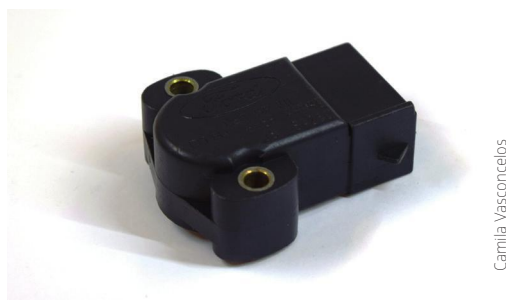
Figura 16 – Sensor de posição da borboleta de aceleração.
