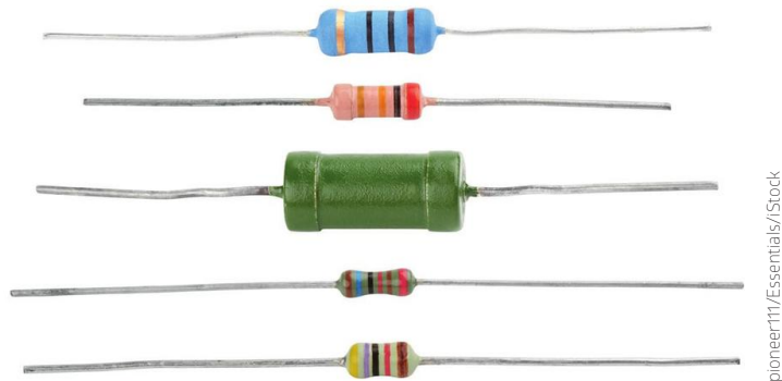
Figura 3 – Resistores de filme de carbono.
