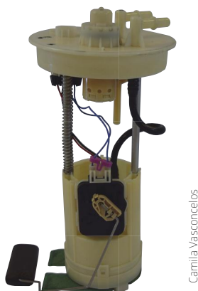
Figura 5 – Bomba de combustível do motor Rocam flex .
