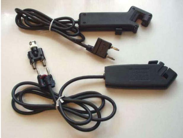
Estas sondas de RPM diseñadas para multímetros digitales, pueden utilizarse para obtener patrones de ignición.
