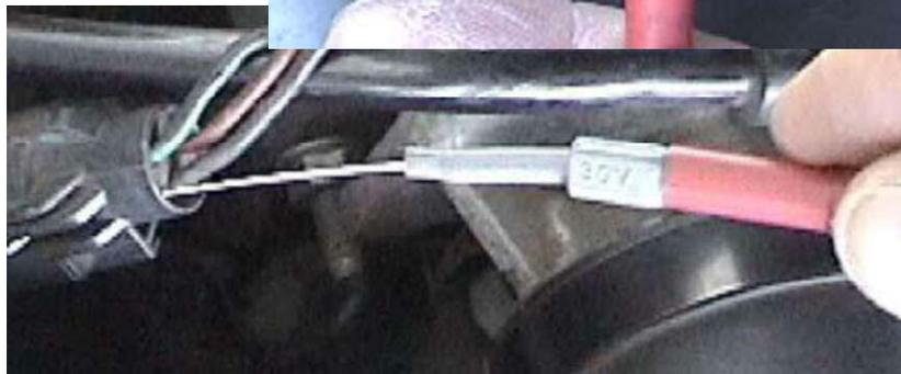
Esto te muestra lo que profundo que tendrás que llegar para hacer contacto con la terminal de metal dentro del conector.
