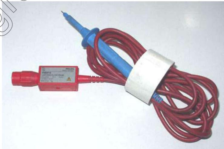
Algunos osciloscopios ya tienen una protección de fábrica que pueden engañarte si no te percatas antes. Tienen un diodo zener en el interior para protegerlos. Si el osciloscopio detecta un alto voltaje sin filtrar, aterriza la señal, y el vehículo deja de funcionar. (Y además no verás ningún patrón.) Y tal vez podrás
