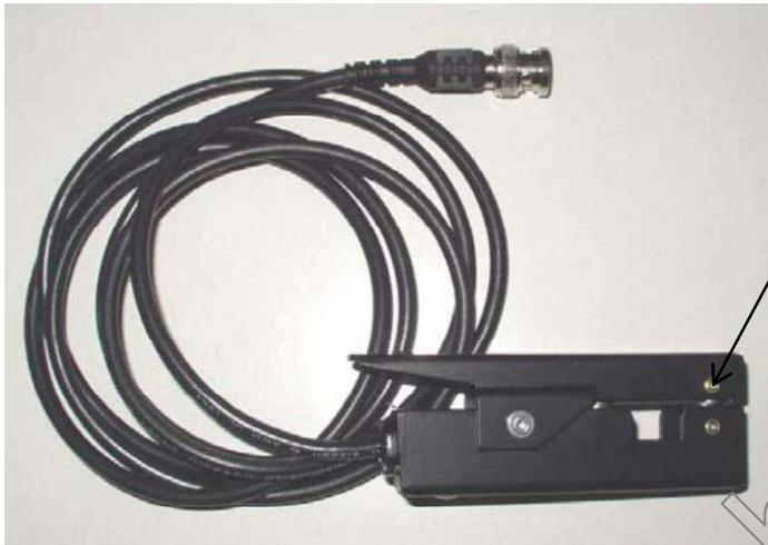
Estos remaches apuntan en dirección hacia la bujía. Engánchalo alrededor del cable de bujía y trata de mantener a otros cables de bujía alejados para que no haya interferencia por señales múltiples.
