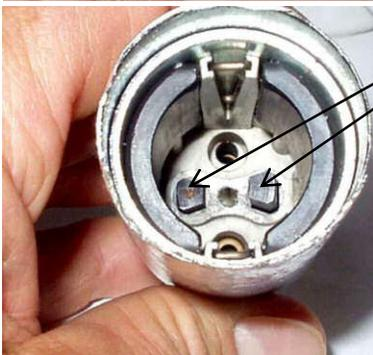
Estas escobillas de bomba de combustible hacen contacto con los segmentos del conmutador para activar el motor de la bomba de combustible.
