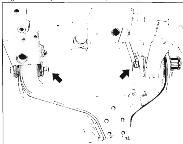
Fig. 14 – Conjunto de la horquilla inferior
