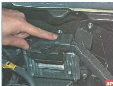
Нажимаем на фиксатор скобы крепления колодки жгута проводов системы управления двигателем...
