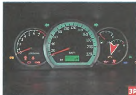
Сигнализатор неисправности системы управления двигателем в комбинации приборов
