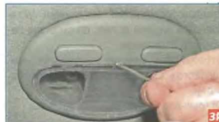
Отверткой поддеваем рассеиватель плафона...
