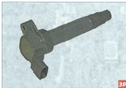
Катушка зажигания
