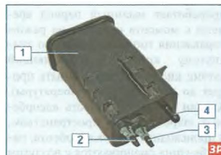
Элементы адсорбера: 1 – корпус адсорбера; 2 – штуцер отвода паров топлива из адсорбера к клапану продувки адсорбера; 3 – штуцер подвода паров топлива к адсорберу из бака; 4 – штуцер подвода воздуха
