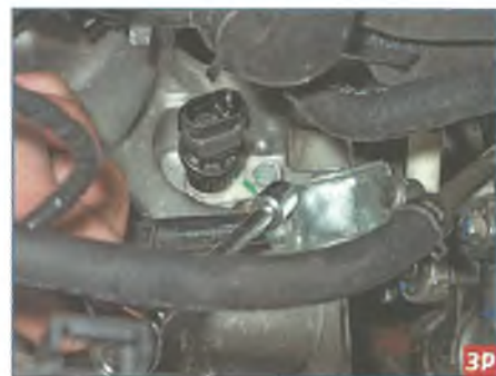
Головкой «на 10» с удлинителем отворачиваем болт крепления привода датчика скорости...
