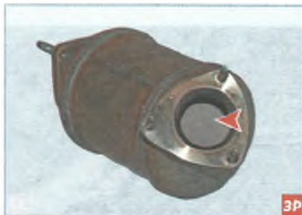
Керамический блок каталитического нейтрализатора
