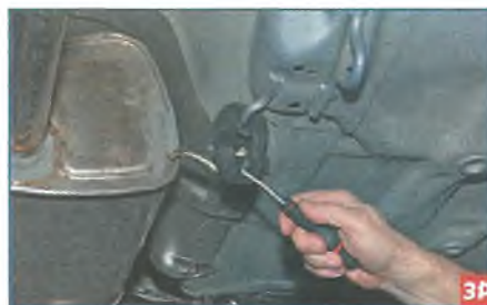
Элементы подвески системы выпуска отработавших газов: 1 — передняя подушка подвески основного глушителя; 2 — задние подушки подвески основного глушителя; 3 — подушки подвески заднего дополнительного глушителя
