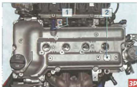
Расположение элементов системы вентиляции картера на крышке головки блока цилиндров: 1 – клапан системы вентиляции картера; 2 – отверстие для подвода картерных газов в полость крышки катушек зажигания
