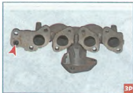
Отверстие во фланце патрубка 4-го цилиндра выпускного коллектора, через которое отработавшие газы отбираются для системы рециркуляции
