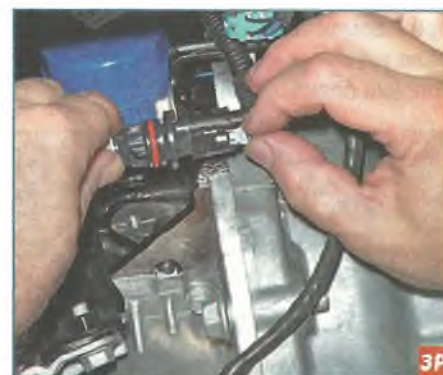
Выдвигаем фиксатор (белого цвета) колодки жгута проводов системы управления двигателем...
