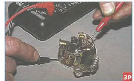
Омметром проверяем держатели изолированных щеток на замыкание с «массой».
