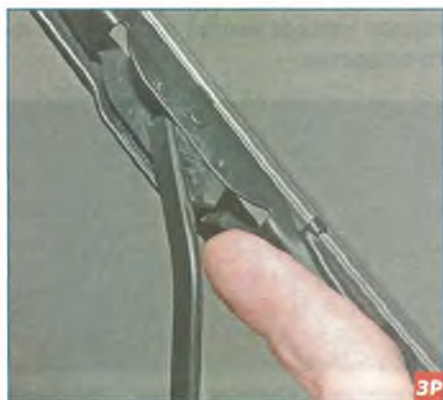
Нажимаем язычок фиксатора щетки...
