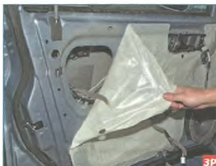
Осторожно отклеиваем влагозащитную пленку.
