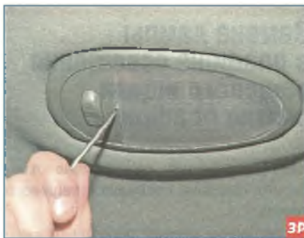
Отверткой поддеваем рассеиватель плафона...
