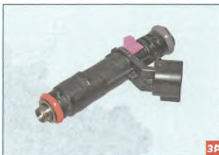
Форсунка с уплотнительными кольцами
