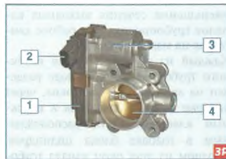
Дроссельный узел: 1 – блок управления дроссельной заслонкой; 2 – электрический разъем; 3 – корпус; 4 – дроссельная заслонка
