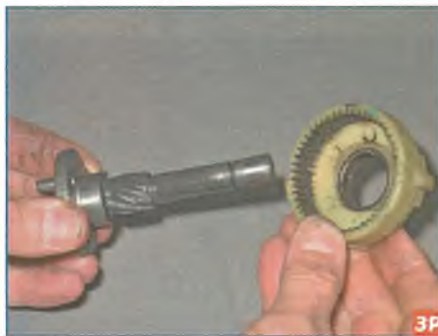
Снимаем коронную шестерню планетарного редуктора.
