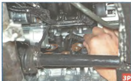
Ключом «на 13» отворачиваем болт крепления датчика к блоку цилиндров и отводим датчик с болтом и жгутом проводов от блока цилиндров.
