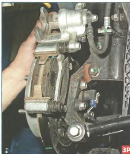
...и поднимаем суппорт, поворачивая его вокруг оси верхнего направляющего пальца.
