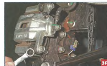
Накидным ключом «на 14» отворачиваем болт нижнего крепления суппорта к направляющему пальцу.
