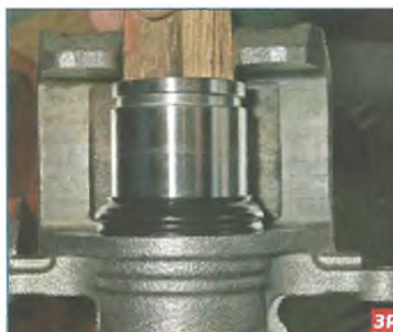
...и, надавливая на него деревянным бруском, утапливаем поршень в цилиндр суппорта.
