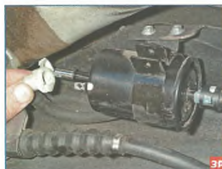
...и снимаем наконечник (белого цвета) подводящей трубки со штуцера фильтра.
