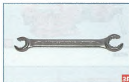
Ключ разрезной «на 22»
