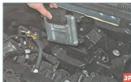
...и снимаем блок управления со шпильки щитка передка.
