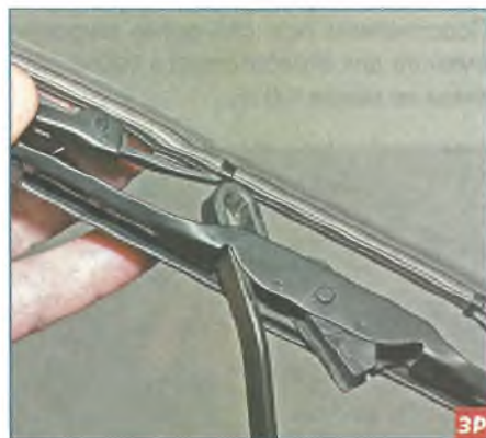
...и сдвигаем щетку к основанию рычага, так чтобы фиксатор щетки вышел из крюка рычага.
