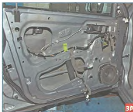
Вид двери со снятыми обивкой и влагозащитной пленкой.
