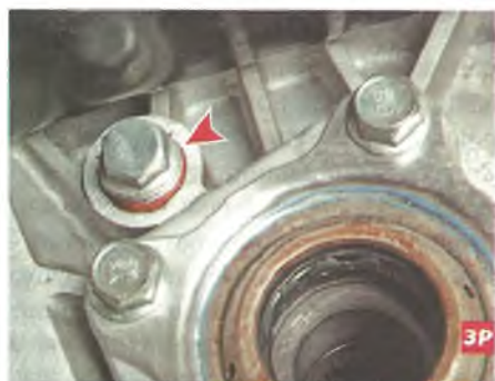
Расположение пробки контрольного отверстия уровня масла в коробке передач (для наглядности привод правого колеса снят)
