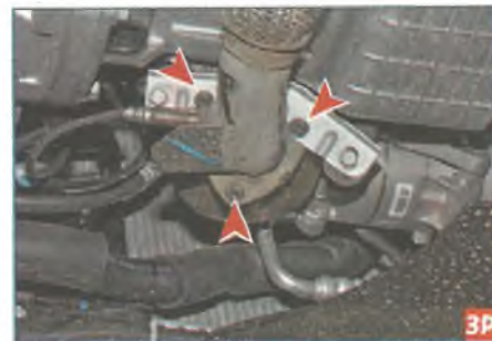
...промежуточной трубы к каталитическому нейтрализатору...
