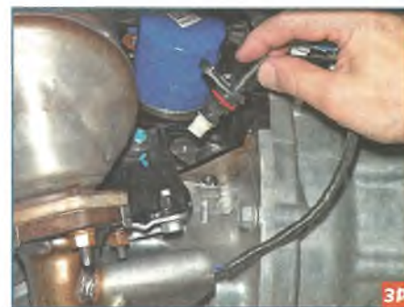
...и вынимаем датчик из гнезда в блоке цилиндров.
