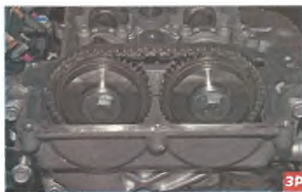
Цепной привод распределительных валов
