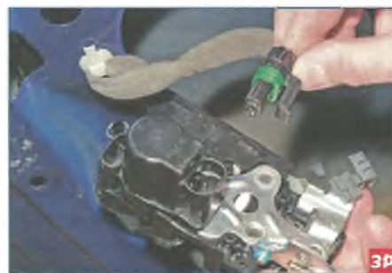
Отжав фиксатор, снимаем колодку проводов с разъема электропривода замка.
