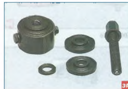
Съемник чашечный для выпрессовки и запрессовки подшипников ступиц
