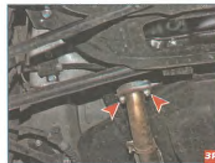
...трубы заднего дополнительного глушителя к трубе основного глушителя. Проверяем состояние резиновых подушек подвески...
