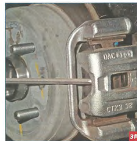
...сдвигаем суппорт, утапливая поршень в цилиндр.
