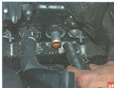
Снимаем шланг с патрубка радиатора отопителя.
