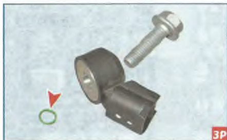
Снимаем с резьбовой части болта резиновое кольцо, препятствующее выпадению болта из отверстия датчика, и вынимаем болт (для наглядности показано на демонтированном датчике).
