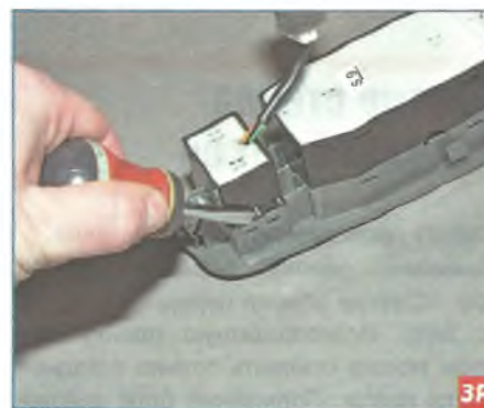
...отверткой отжимаем края панели подлокотника двери...
