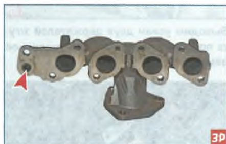
Из выпускного коллектора отработавшие газы попадают в полость левого торца головки блока цилиндров через канал, выполненный во фланце патрубка 4-го цилиндра
