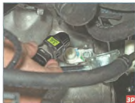
Вращаем датчик против часовой стрелки рукой (или ключом «на 27» за шестигранник на его корпусе) и отворачиваем датчик от корпуса привода датчика.
