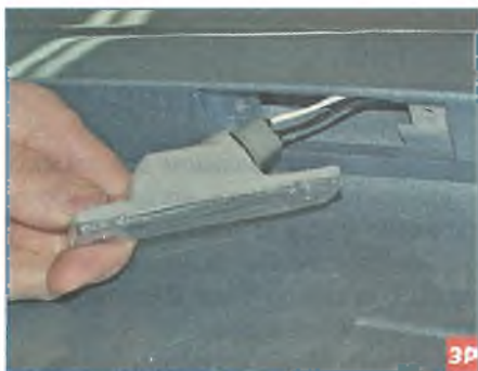
Вынимаем фонарь из крышки багажника.
