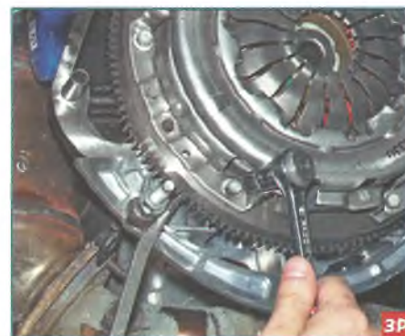
Накидным ключом «на 10» ослабляем затяжку штуцера прокачки, удерживая переходник шланга за лыски ключом «на 19».
