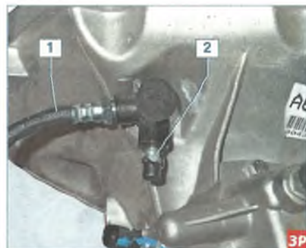
Переходник трубки подвода жидкости к рабочему цилиндру со шлангом 1 и штуцером прокачки 2
