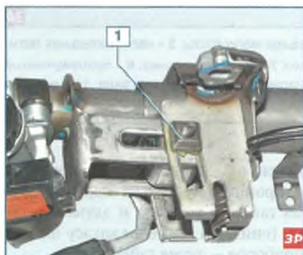
Рулевая колонка (вид с правой стороны): 1 – гайка оси рычага регулировки положения рулевой колонки
