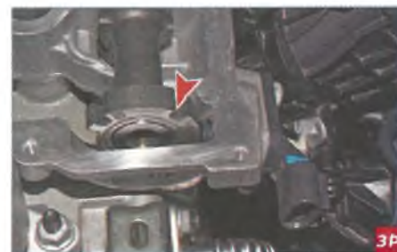
На хвостовике распределительного вала впускных клапанов установлен задающий диск датчика положения распределительного вала
