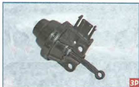
Пневмокамера механизмов изменения геометрии каналов во впускном трубопроводе
