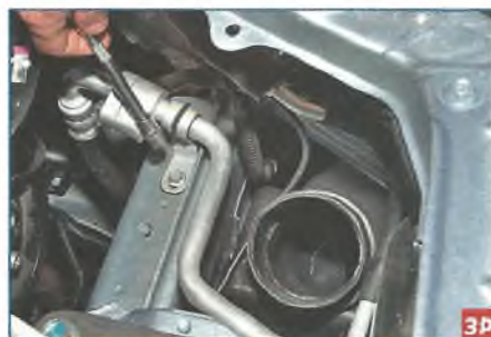
Тем же инструментом отворачиваем болт крепления к правому лонжерону кронштейна трубопровода низкого давления кондиционера.
