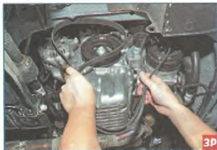
Вынимаем ремень из моторного отсека.
