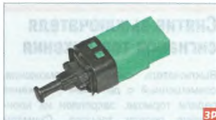
Выключатель сигналов торможения
