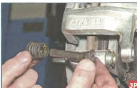
Снимаем защитный чехол с направляющего пальца.
