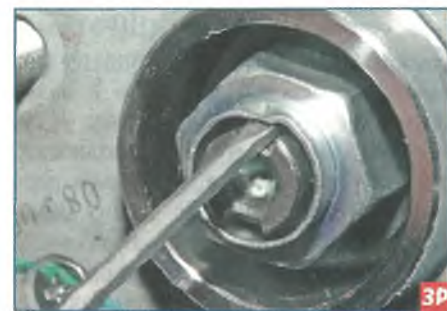
Лезвием шлицевой отвертки выправляем замятый поясик гайки подшипника ступицы.
