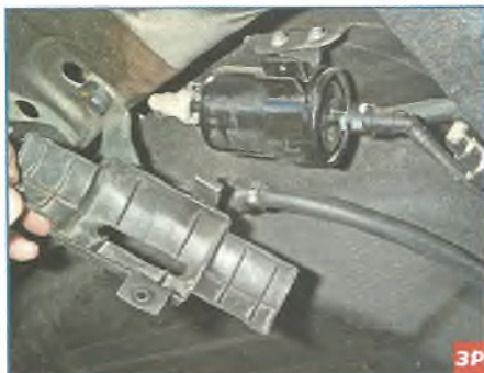
Снимаем защитный кожух фильтра.
