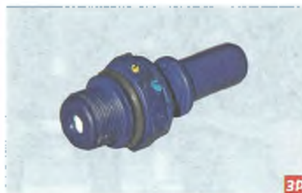
Клапан системы вентиляции картера
