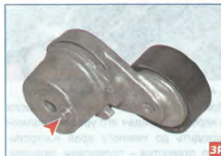
...выступ на корпусе натяжного устройства...
