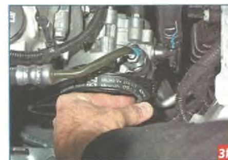
...и сдвигаем ремень со шкива насоса гидроусилителя.
