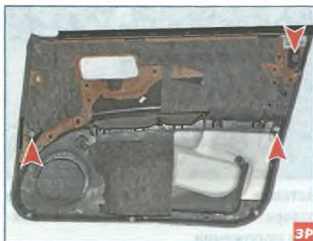
Расположение пистонов с внутренней стороны обивки передней двери.
