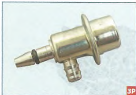
Регулятор давления топлива
