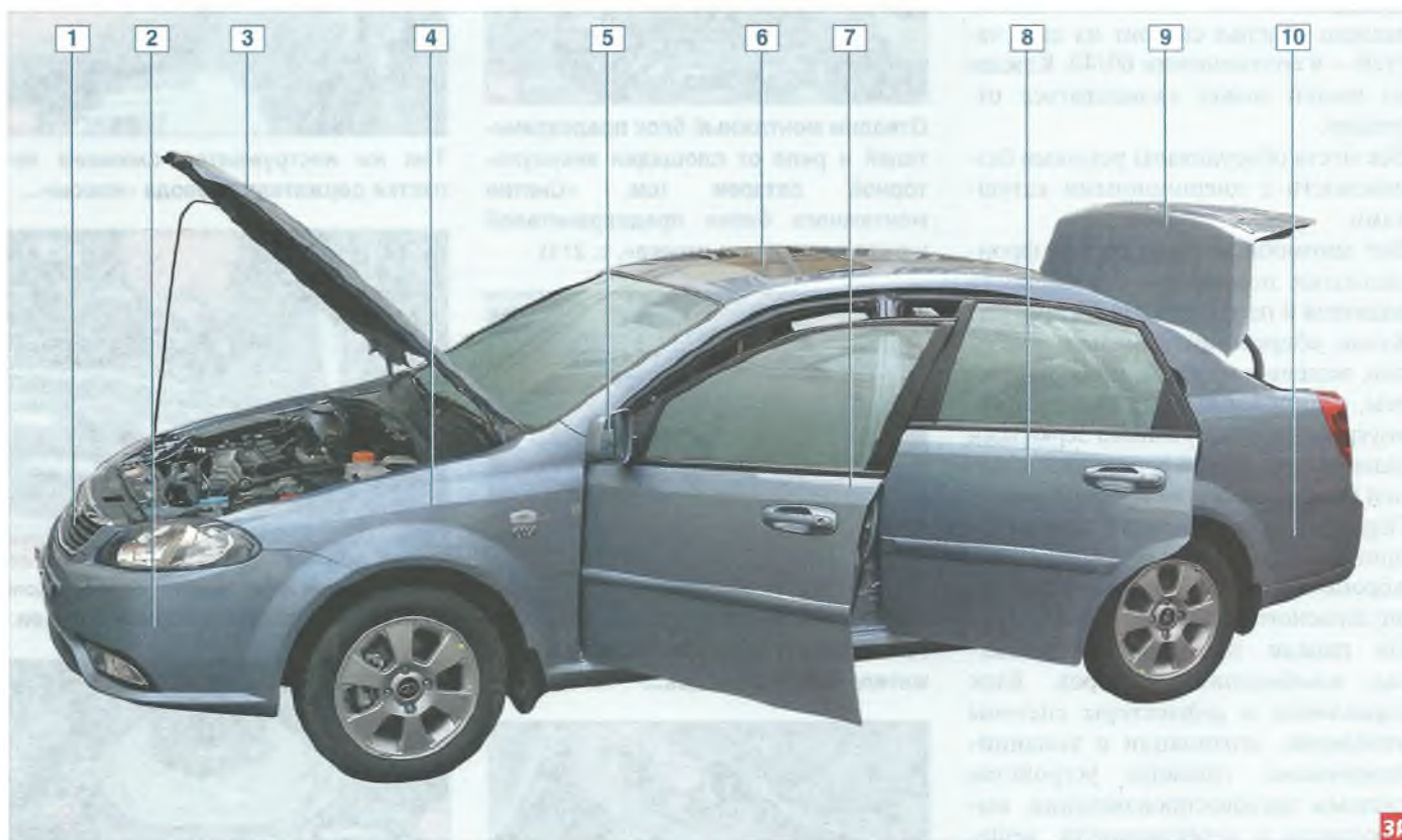
Съемные элементы кузова автомобиля: 1 – облицовка радиатора; 2 – передний бампер; 3 – капот; 4 – переднее крыло; 5 – наружное зеркало заднего вида; 6 – люк; 7 – передняя дверь; 8 – задняя дверь; 9 – крышка багажника; 10 – задний бампер
