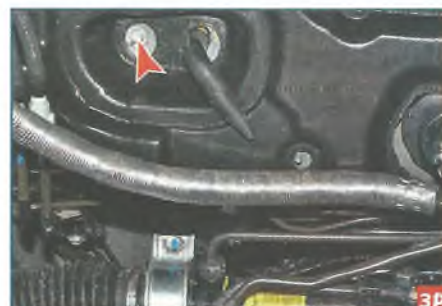
...и еще один болт – рядом с трубкой слива конденсата из корпуса отопителя (для наглядности показано при демонтированном силовом агрегате).
