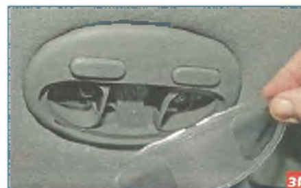
...и снимаем рассеиватель.
