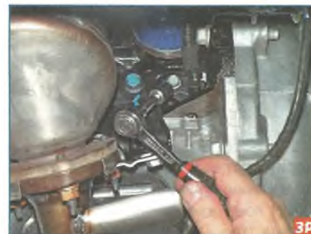
Головкой «на 10» отворачиваем болт крепления датчика...
