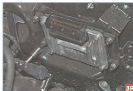
Головкой «на 10» отворачиваем четыре гайки крепления блока управления к щитку передка...
