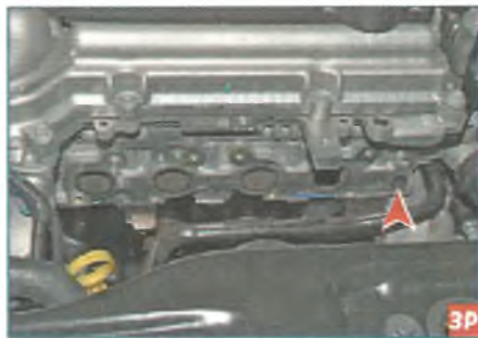
Отверстие в головке блока цилиндров, через которое отработавшие газы из выпускного коллектора подводятся к клапану рециркуляции
