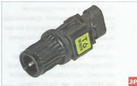
Датчик скорости автомобиля
