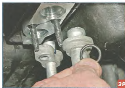
Соединения фланцев трубопроводов с редуктором уплотняются резиновыми кольцами.
