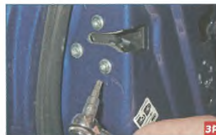
Ключом Torx-T30 отворачиваем три винта крепления замка.
