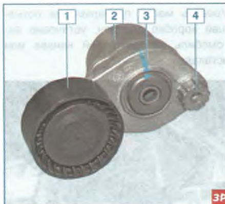
Натяжное устройство: 1 – натяжной ролик; 2 – корпус; 3 – кронштейн ролика; 4 – выступ под ключ.
