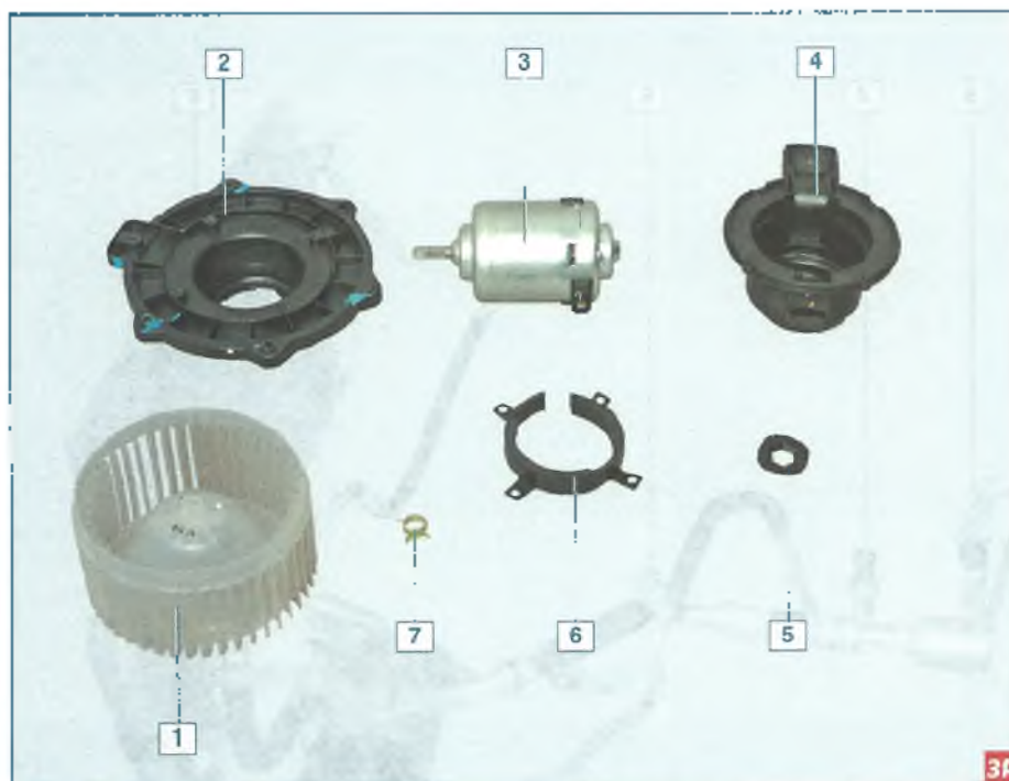
Детали вентилятора отопителя: 1 – крыльчатка; 2 – основание; 3 – электродвигатель вентилятора; 4 – кожух электродвигателя; 5 – подкладка электродвигателя; 6 – держатель электродвигателя; 7 – хомут
