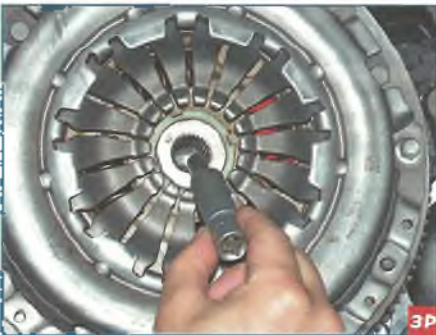
Центрирующая оправка.
