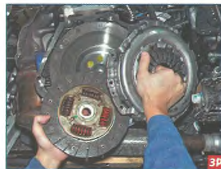
Снимаем «корзину» и ведомый диск сцепления.
