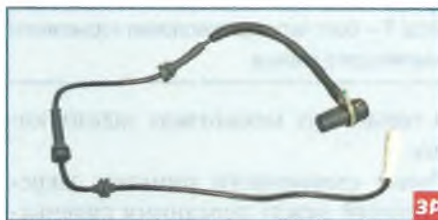
Датчик скорости вращения переднего колеса
