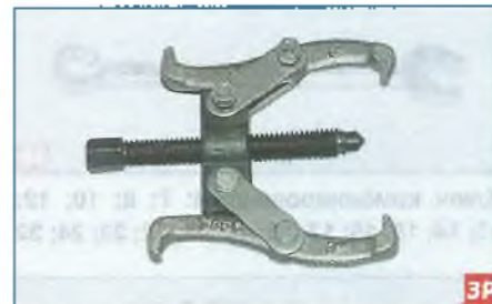
Съемник двухзахватный
