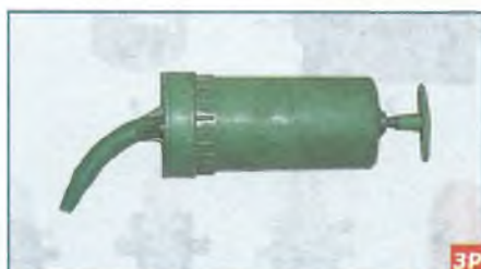
Шприц для заливки трансмиссионного масла
