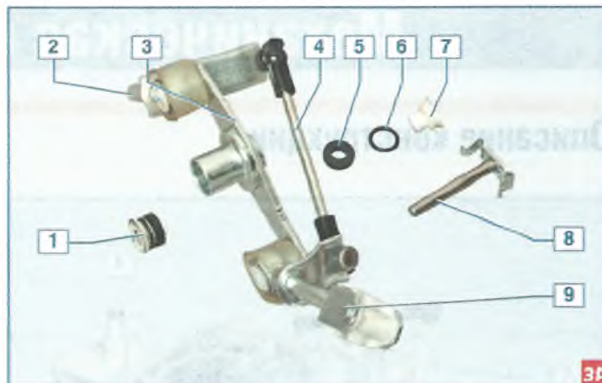
Элементы привода механизма переключения передач: 1 – подшипник; 2 – входной вал; 3 – коромысло; 4 – тяга; 5 – демпфер подшипника; 6 – уплотнительное кольцо; 7 – втулка подшипника; 8 – ось коромысла; 9 – выходной вал
