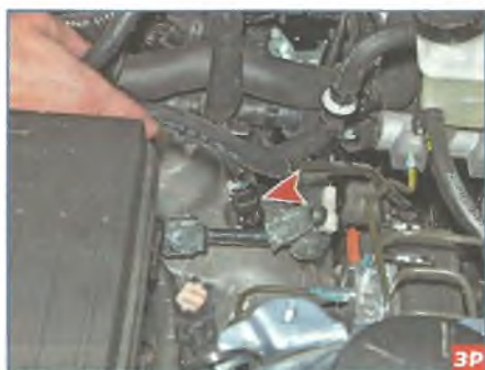
Расположение датчика скорости автомобиля на картере коробки передач.
