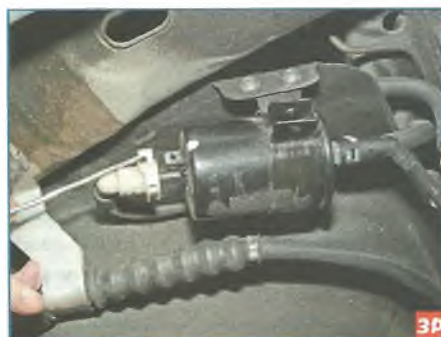
Отверткой выдвигаем фиксатор из наконечника топливной трубки...
