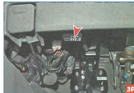
Расположение колодки диагностики в салоне автомобиля
