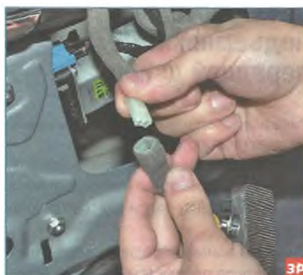
...вынимаем внутреннюю колодку проводов из наружной...
