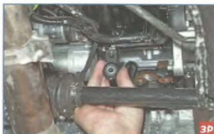
...и вынимаем датчик детонации. Перед установкой датчика очищаем прилив на блоке цилиндров, на который крепится датчик. Устанавливаем датчик детонации в обратной последовательности и затягиваем болт моментом 40 Н·м.
