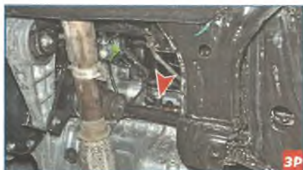
Расположение датчика детонации на блоке цилиндров двигателя.
