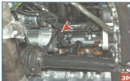
Выдвигаем стопор (красного цвета) фиксатора колодки жгута проводов системы управления двигателем и, нажав на фиксатор...
