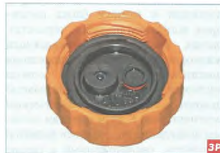
Крышка расширительного бачка
