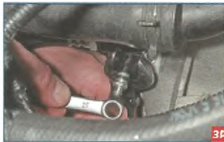
Накидным ключом «на 10» ослабляем затяжку штуцера прокачки, удерживая переходник шланга за лыски ключом «на 19».
