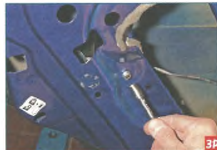
Головкой «на 10» отворачиваем гайку нижнего крепления задней направляющей.
