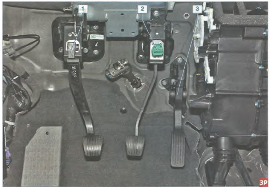
Место установки в салоне автомобиля датчика положения педали сцепления 1 (автомобиль с механической коробкой передач), выключателя сигналов торможения 2 и модуля педали «газа» 3 (для наглядности показано при снятых рулевой колонке и панели приборов)
