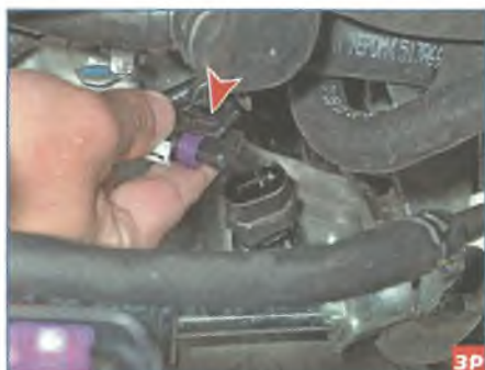
Отжав фиксатор колодки жгута проводов системы управления двигателем,
