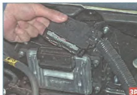
...и отсоединяем колодку жгута проводов от разъема блока.
