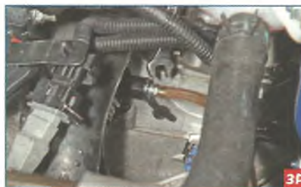
Накидным ключом «на 10» ослабляем затяжку штуцера прокачки, удерживая переходник шланга за лыски ключом «на 19».
