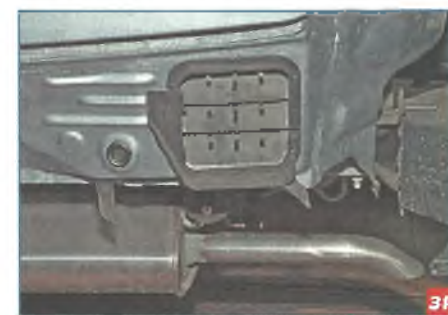
Клапаны выхода воздуха из салона (показано при снятом заднем бампере)
