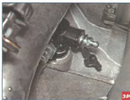
Снимаем защитный колпачок со штуцера прокачки гидропривода сцепления.
