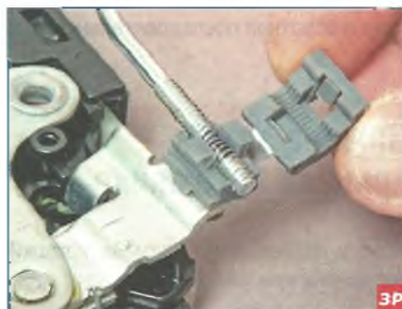
Раскрываем фиксатор и освобождаем тягу.
