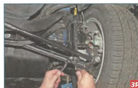
Элементы задней подвески на автомобиле: 1 – подрамник; 2 – задний поперечный рычаг; 3 – передний поперечный рычаг; 4 – пружина амортизаторной стойки; 5 – телескопическая стойка; 6 – стойка стабилизатора поперечной устойчивости; 7 – кулак; 8 – продольный рычаг; 9 – кронштейн; 10 – скоба; 11 – штанга стабилизатора поперечной устойчивости
