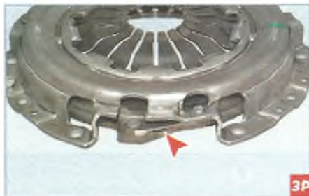
Блок из четырех упругих пластин
