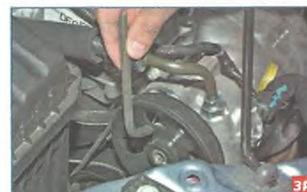
Через отверстия в шкиве насоса шестигранником «на 8» ослабляем затяжку трех винтов крепления насоса.
