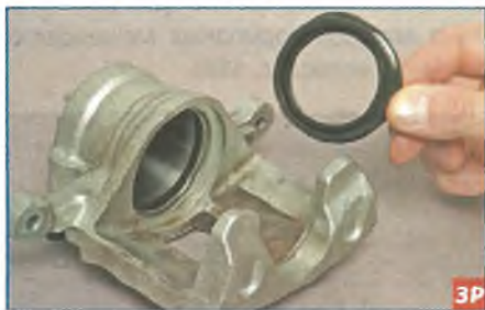
Извлекаем из суппорта защитный чехол.
