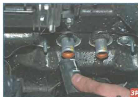
Аналогично снимаем другой шланг с патрубка радиатора отопителя.
