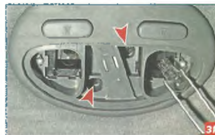
...вынимаем лампу индивидуального освещения пинцетом.
