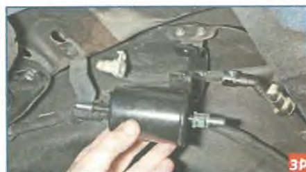
Вынимаем топливный фильтр из кронштейна.
