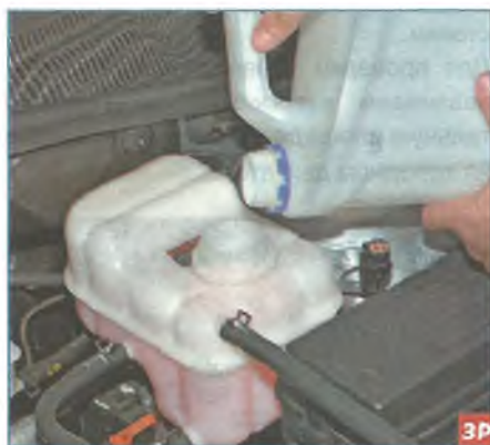
Доливаем в бачок охлаждающую жидкость, немного не доводя уровень до метки MAX.
