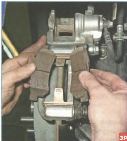
Вынимаем тормозные колодки из направляющей.
