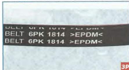
Маркировка ремня привода вспомогательных агрегатов 6PK 1814 (шестиклиновой, длиной 1814 мм).
