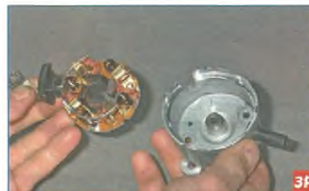
...и вынимаем щеткодержатель из задней крышки.
