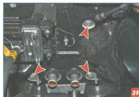
Головкой «на 10» с удлинителем отворачиваем три болта крепления корпуса отопителя к щитку передка.
