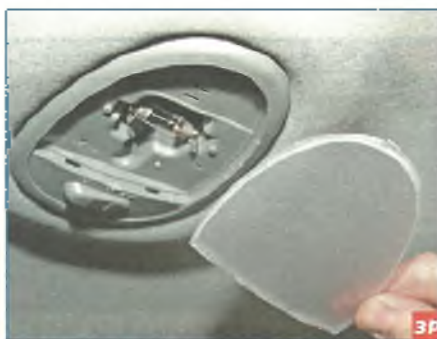
...и снимаем рассеиватель.
