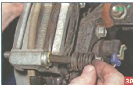
...вынимаем направляющий палец с чехлом из отверстия направляющей колодок.
