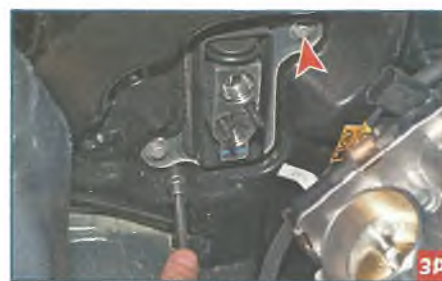
Тем же инструментом отворачиваем два болта крепления корпуса отопителя к щитку передка в зоне редуктора кондиционера...
