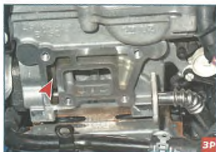
Полость в левом торце головки блока цилиндров для прохода отработавших газов из выпускного коллектора (показано при снятом выпускном патрубке системы охлаждения)
