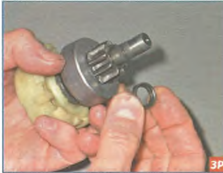
Снимаем ограничительное кольцо.
