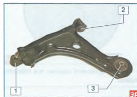
Рычаг передней подвески: 1 – шаровая опора; 2 – сайлент-блок переднего крепления к подрамнику; 3 – сайлент-блок заднего крепления к подрамнику
