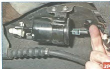
...и снимаем наконечник (черного цвета) отводящей трубки со штуцера фильтра.
