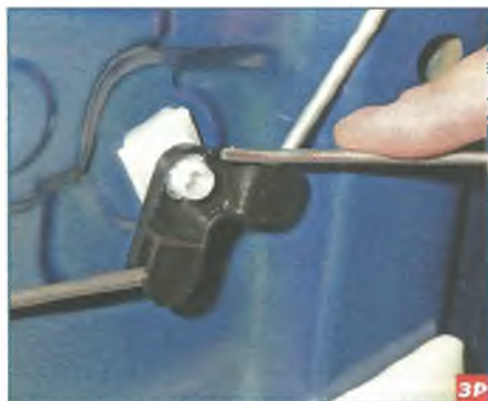
Отверткой последовательно утапливаем четыре усика оси рычага.
