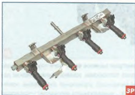
Топливная рампа с форсунками
