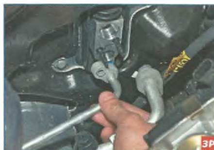
...и отсоединяем фланцы трубопроводов от редуктора.
