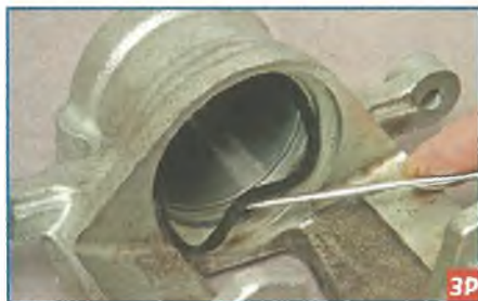
Поддеваем отверткой уплотнительное кольцо поршня...
