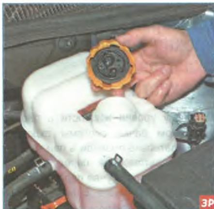
...отворачиваем крышку расширительного бачка.
