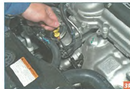
...и вынимаем указатель уровня масла (щуп).
