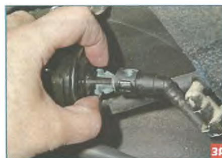
Сжимаем «усики» пластмассового фиксатора наконечника топливной трубки...
