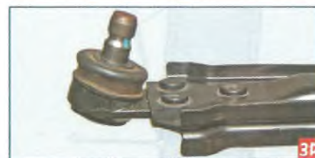
В заводском исполнении корпус шаровой опоры прикреплен к рычагу тремя заклепками
