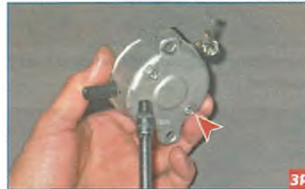
Головкой Е-6 отворачиваем два винта...
