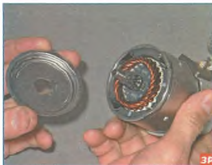
Снимаем крышку электродвигателя с корпуса стартера.
