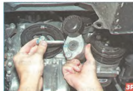
Вынимаем болт и снимаем натяжное устройство.
