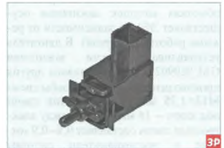
Датчик положения педали сцепления
