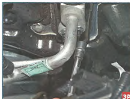
Головкой «на 10» с удлинителем отворачиваем две гайки крепления фланцев трубопроводов к редуктору кондиционера...
