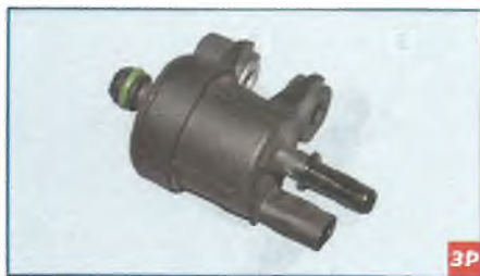
Электромагнитный клапан продувки адсорбера
