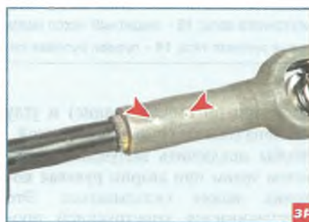
При аварии срезаются два пластмассовых штифта, соединяющих части вала
