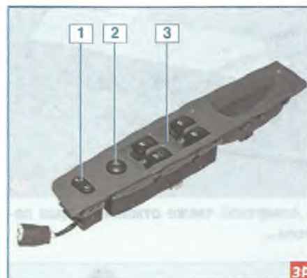
Расположение выключателей на панели подлокотника двери: 1 – кнопка выключателя центрального замка дверей; 2 – кнопка блокировки выключателей электростеклоподъемников двери переднего пассажира и задних дверей; 3 – блок выключателей электростеклоподъемников передних и задних дверей.
