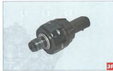
Датчик сигнализатора недостаточного давления масла
