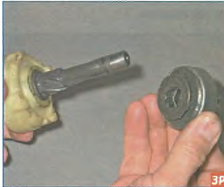
Снимаем обгонную муфту с шестерней привода в сборе.
