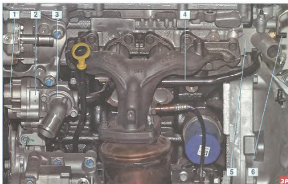
Элементы системы охлаждения (вид спереди, для наглядности показано на демонтированном силовом агрегате): 1 – насос охлаждающей жидкости; 2 – передняя крышка блока цилиндров; 3 – корпус термостата; 4 – трубка подвода жидкости к насосу; 5 – выпускной патрубок системы охлаждения; 6 – датчик температуры охлаждающей жидкости
