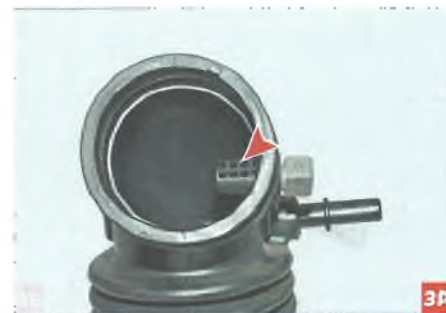
Датчик температуры воздуха на впуске
