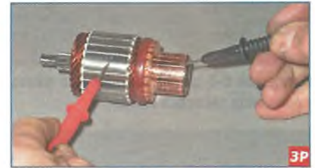
...подсоединяем щупы тестера (в режиме омметра) к коллектору и «железу» якоря.
