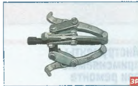
Съемник трехзахватный
