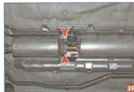
...переднего дополнительного глушителя к трубе заднего дополнительного глушителя (третья гайка на фото не видна)...
