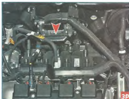
Расположение ЭБУ в моторном отсеке.
