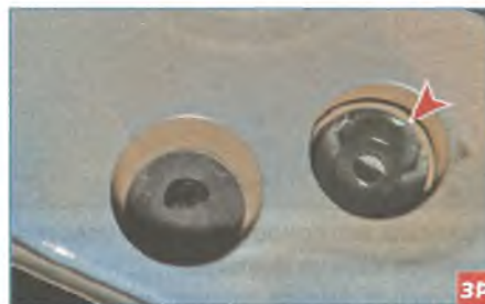
Доливаем в бачок охлаждающую жидкость, немного не доводя уровень до метки MAX.
