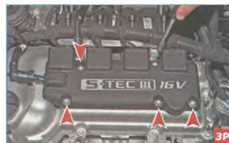
Головкой «на 10» отворачиваем пять болтов крепления крышки катушек зажигания.
