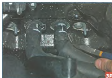
Пассатижами сжимаем концы хомута крепления шланга к патрубку радиатора отопителя и сдвигаем хомут по шлангу.
