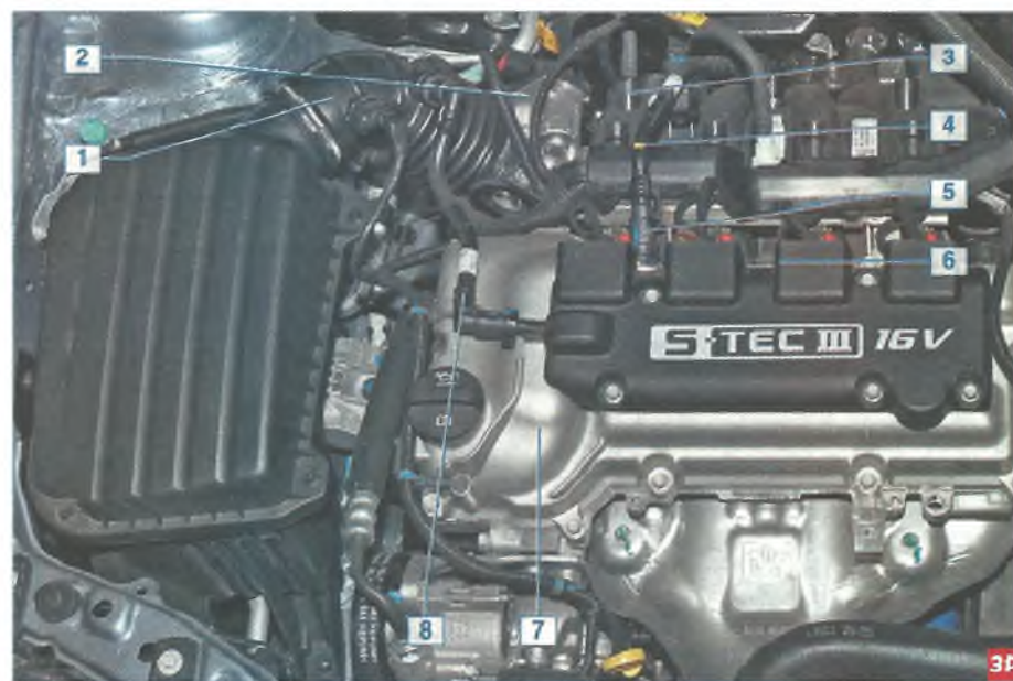
Элементы системы вентиляции картера: 1 — шланг подвода воздуха к дроссельному узлу; 2 — дроссельный узел; 3 — впускной трубопровод; 4 — трубка подвода картерных газов к впускному трубопроводу; 5 — клапан системы вентиляции картера; 6 — крышка катушек зажигания; 7 — крышка головки блока цилиндров; 8 — трубка подвода картерных газов к дроссельному узлу
