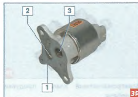
Клапан рециркуляции отработавших газов: 1 – фланец соединения с выпускным патрубком системы охлаждения; 2 – канал отвода отработавших газов из клапана; 3 – канал подвода отработавших газов к клапану
