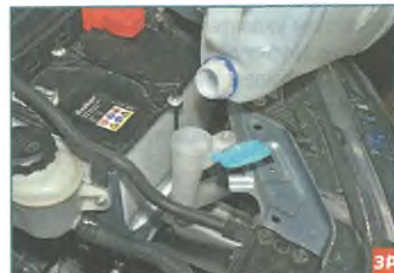
Доливаем жидкость и контролируем ее уровень через полупрозрачную стенку горловины.
