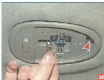
Вынимаем лампу освещения салона... ...и заменяем ее новой лампой C10W. Если необходимо снять плафон, крестообразной отверткой отворачиваем саморез крепления плафона (показан на фото стрелкой).
