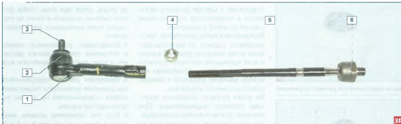
Рулевая тяга с наконечником: 1 – наконечник; 2 – пыльник; 3 – палец шарового шарнира наконечника; 4 – контргайка; 5 – тяга; 6 – корпус шарнира тяги
