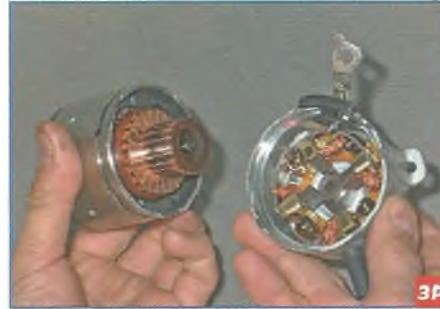
Снимаем заднюю крышку со щеткодержателем.
