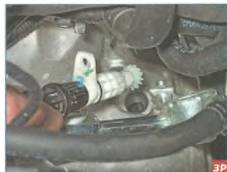
...и вынимаем привод (с датчиком в сборе) из гнезда картера коробки передач.
