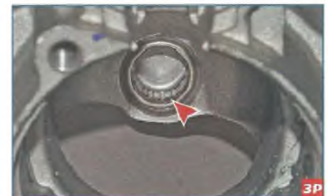
Проверяем состояние игольчатого подшипника в передней крышке стартера.
