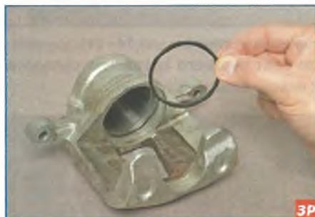
...и вынимаем его из проточки цилиндра суппорта.
