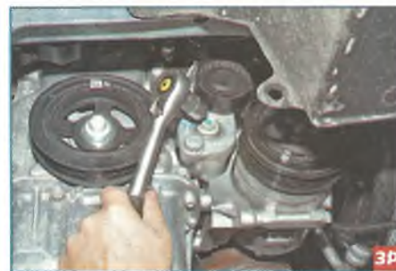
...головкой «на 15» отворачиваем болт крепления натяжного устройства.
