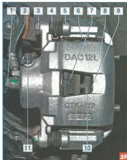
Тормозной механизм переднего колеса: 1 – болт-штуцер крепления наконечника тормозного шланга; 2 – шланг тормозного механизма; 3 – болт крепления суппорта к направляющему пальцу; 4 – чехол направляющего пальца; 5 – направляющая колодок; 6 – пружинная скоба; 7 – внутренняя тормозная колодка; 8 – суппорт; 9 – наружная тормозная колодка; 10 – диск тормозного механизма; 11 – штуцер прокачки гидропривода тормоза
