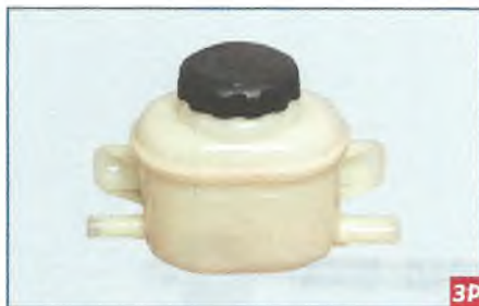
Бачок гидроусилителя рулевого управления
