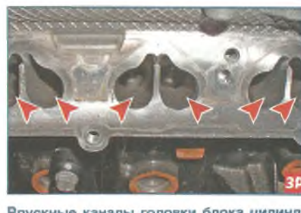
Впускные каналы головки блока цилиндров
