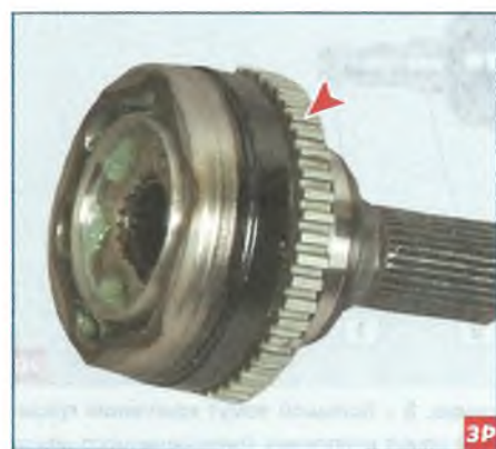
На корпус наружного шарнира напрессован зубчатый венец, обеспечивающий работу датчика скорости вращения колеса антиблокировочной системы тормозов
