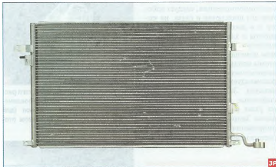
Конденсатор кондиционера
