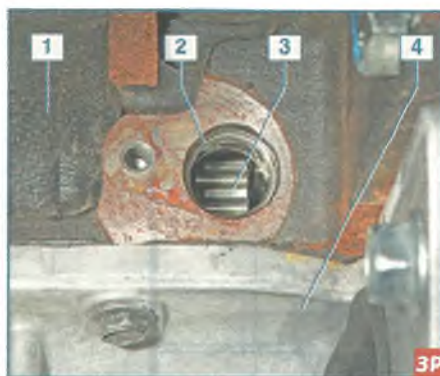
Место установки датчика положения коленчатого вала (показано при снятом датчике): 1 – блок цилиндров; 2 – гнездо датчика; 3 – задающий диск датчика; 4 – поддон картера
