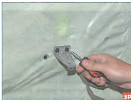
Крестобразной отверткой отворачиваем два самореза крепления кронштейна панели блока выключателей...
