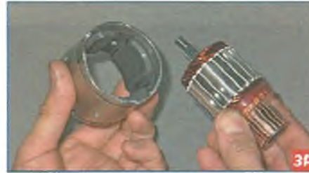
Вынимаем якорь из корпуса стартера.
