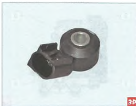
Датчик детонации
