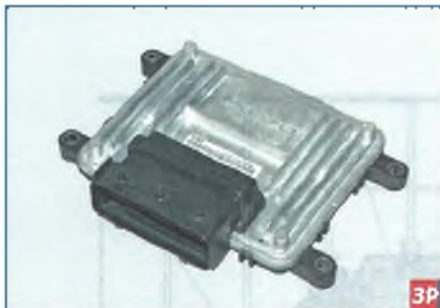
Электронный блок управления двигателем
