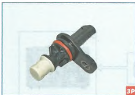
Датчик положения коленчатого вала
