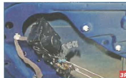
Проведя тягу, вынимаем замок через технологическое отверстие внутренней панели двери.
