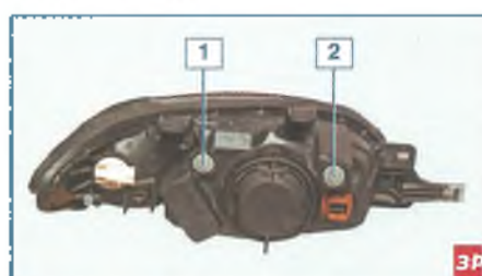
Расположение регуляторов направления пучков света на корпусе фары: 1 – регулятор светового пучка в вертикальной плоскости; 2 – регулятор светового пучка в горизонтальной плоскости
