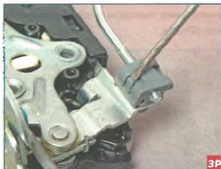
В полости двери отверткой освобождаем фиксатор нижнего конца тяги (для наглядности показано на снятом узле).
