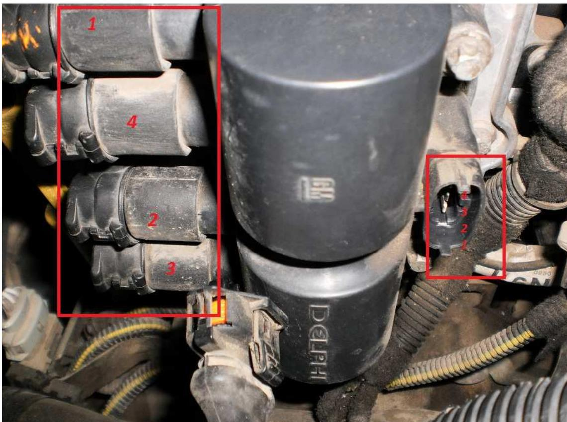
Como podéis observar, hay un conector de 4 pines, que son las bobinas primarias o de entrada, y hay 4 conectores de los cables que van a parar a las bujías, que son las bobinas secundarias o salidas.
