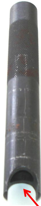
Rebaje para eje de satélites
