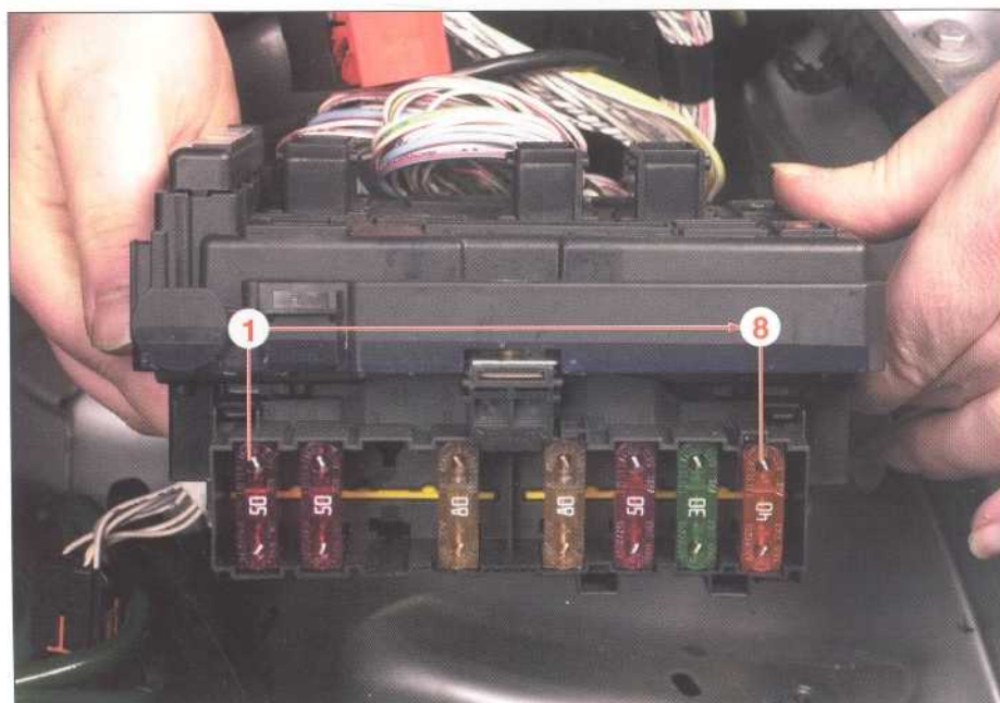
MAXI-FUSIBLES (BH12) DU BOITIER DE SERVITUDE MOTEUR
