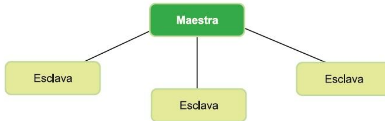
Figura 3.20. Estructura de red maestra-esclava.
