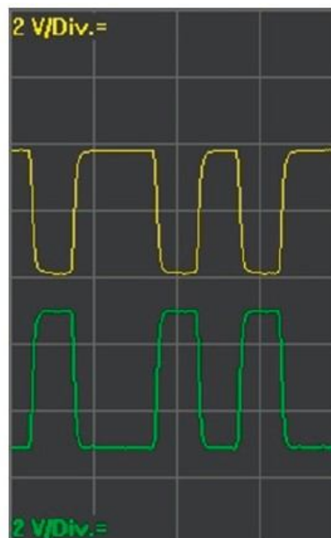
Figura 3.34. Señal CAN Low Speed separados los dos canales
