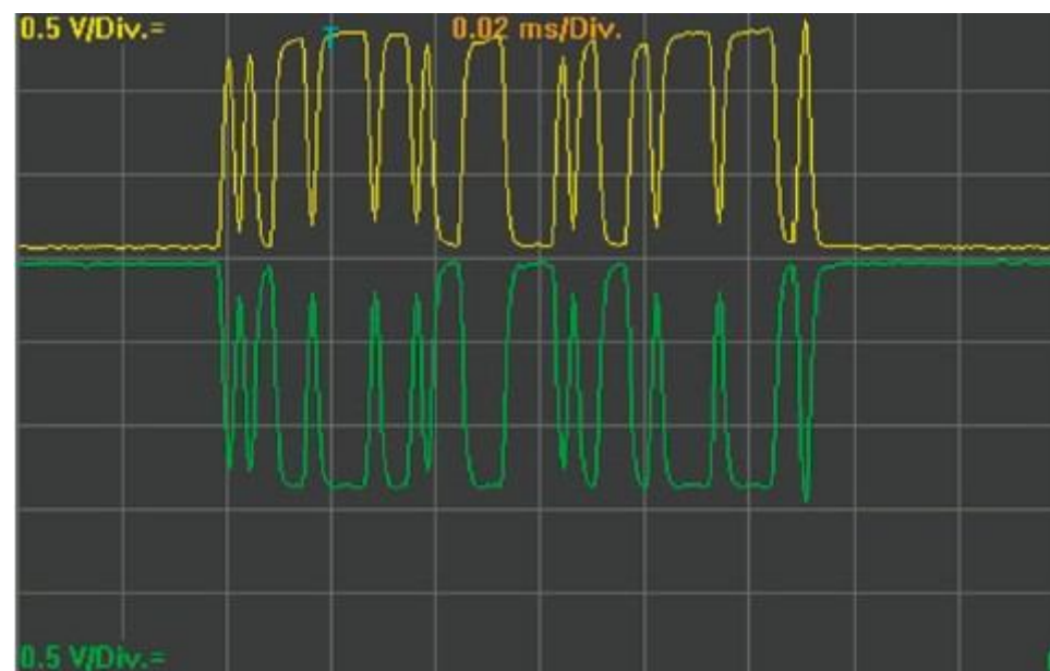
Figura 3.28. Señal de CAN Bus. El bit dominante (0) se da cuando la señal H y L se separan. El bit recesivo (1) cuando las 19 señales se juntan.
