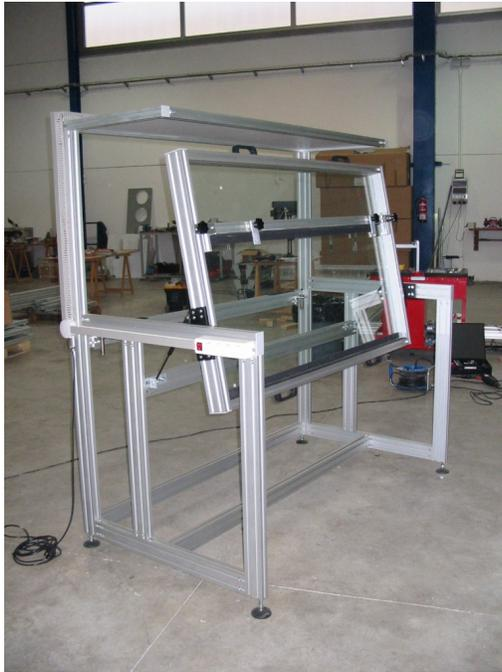
El tablero lleva unas reglas recubiertas de una goma de protección ajustable para encajar, sin peligro de que se caiga la pantalla además este sistema impide que la pantalla esté en contacto directo con el cristal evitando así que se raye.
