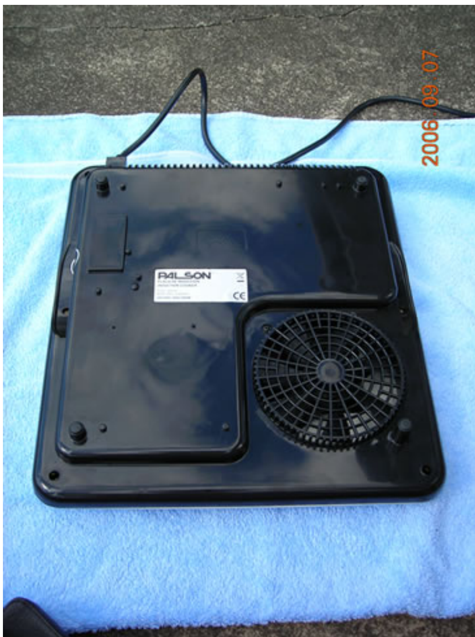
Parte inferior de la cocina, con ventilador de refrigeración.
