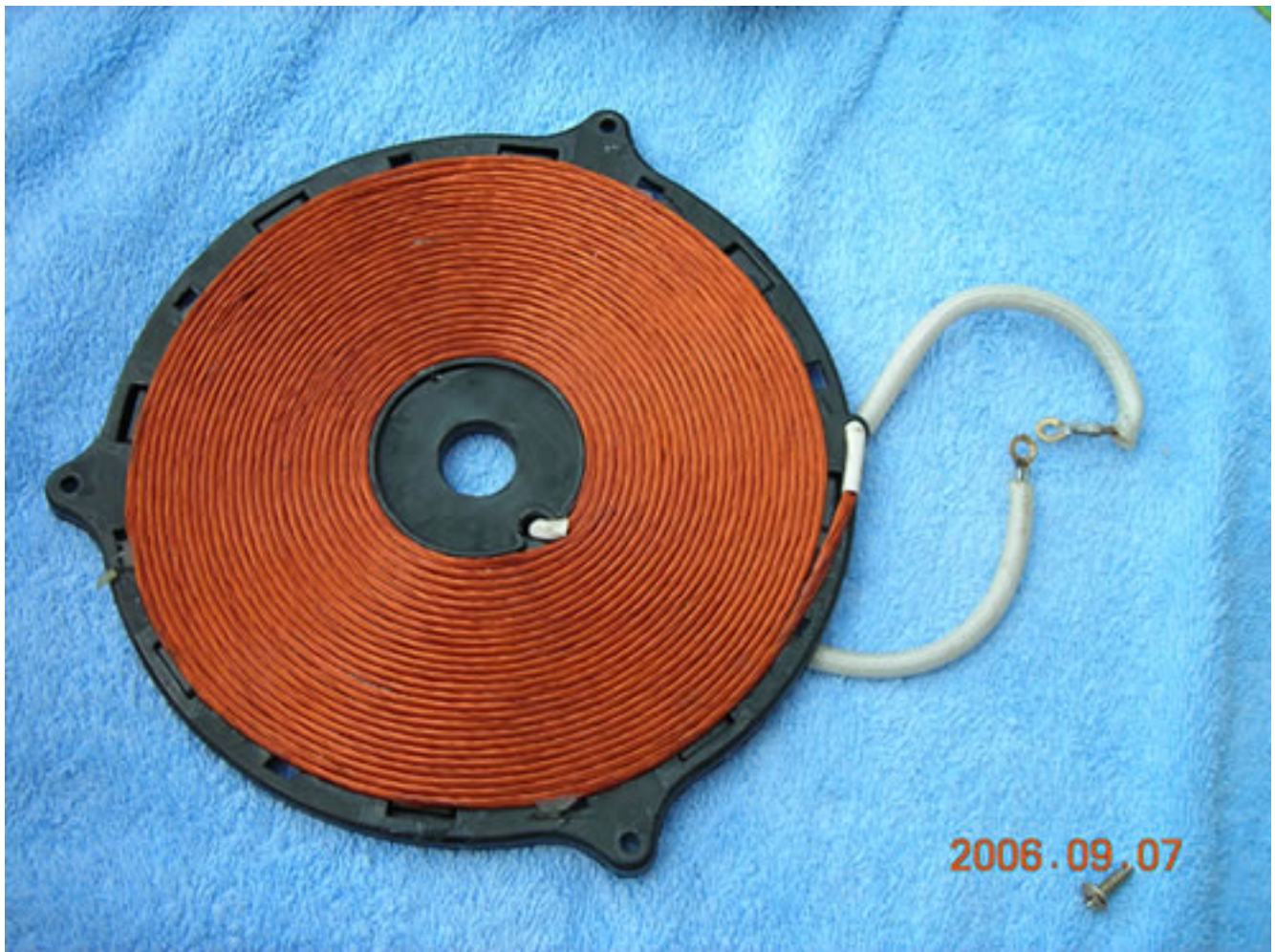
Vista superior de la bobina de inducción y el termostato
