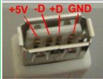
Visión del conector USB tipo A hembra.
